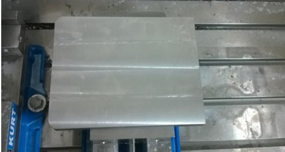
Slika 8.6 Stezanje pozicije u strojni škripac
