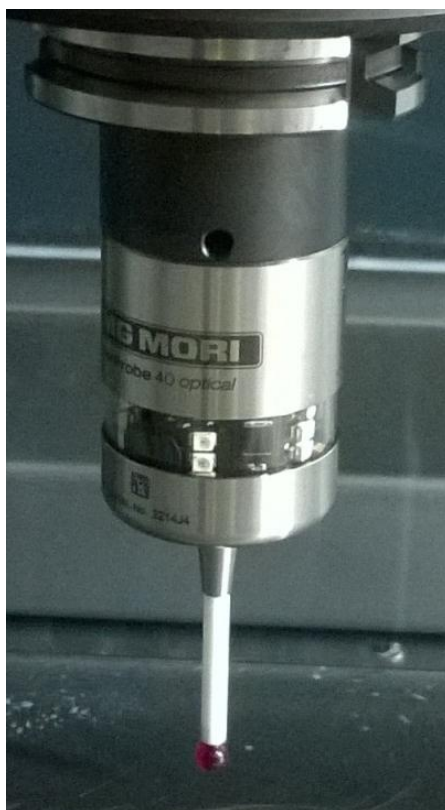
Slika 6.6 Ticalo za umjeravanje
