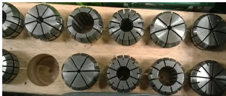
Slika 6.8 Univerzalne elastične čahure raznih promjera
