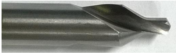
Slika 6.17 Zabušivač Ø8 mm
