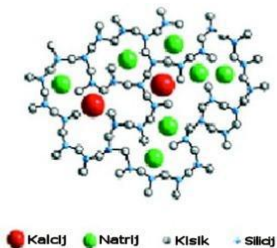
Slika 2: Struktura stakla (www.glaz.hr)
