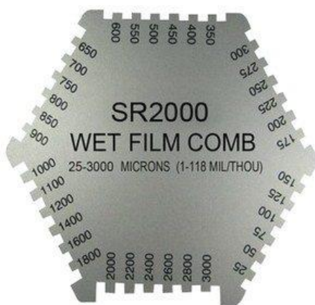
Slika 10. Šesterokutni češalj za mjerenje mokrog filma premaza [14]
