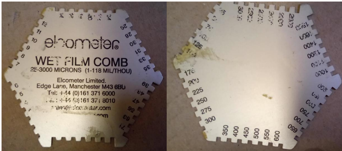
Slika 21. Češalj za ispitivanje mokrog filma premaza
