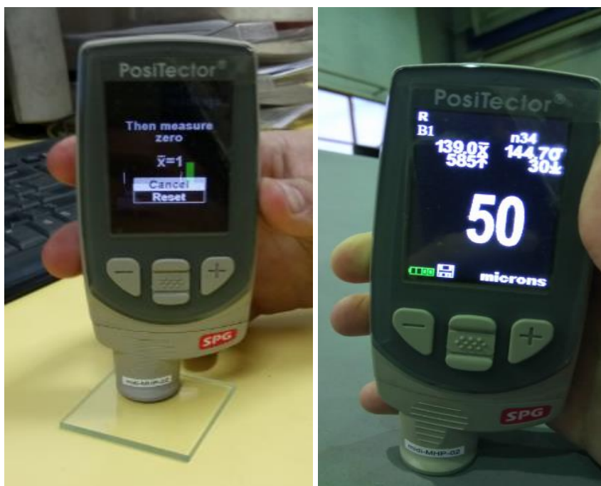
Slika 17. Umjeravanje uređaja i mjerenje hrapavosti na šasiji MV-10
