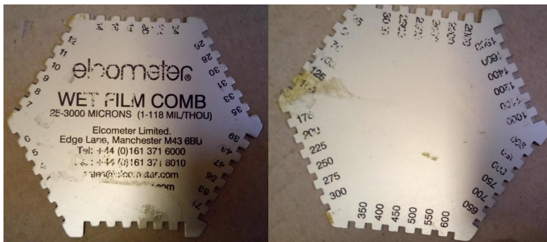
Slika 21. Češalj za ispitivanje mokrog filma premaza
