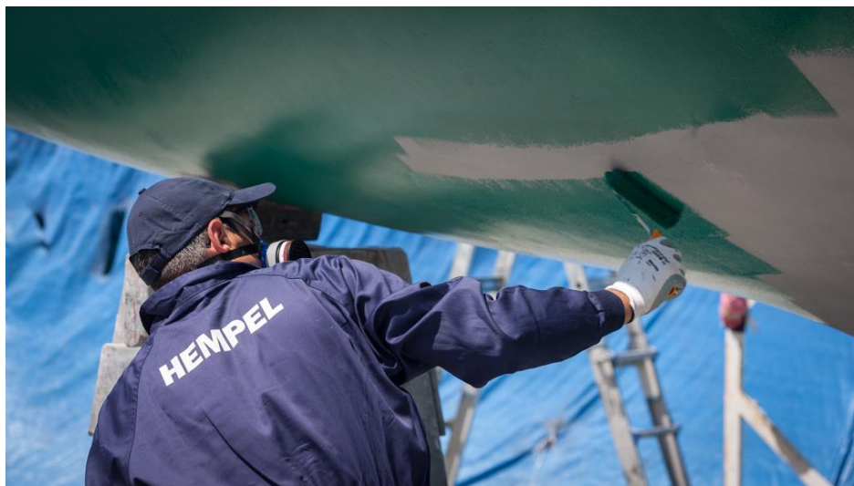
Slika 5. Nanošenje premaza valjkom [7]
