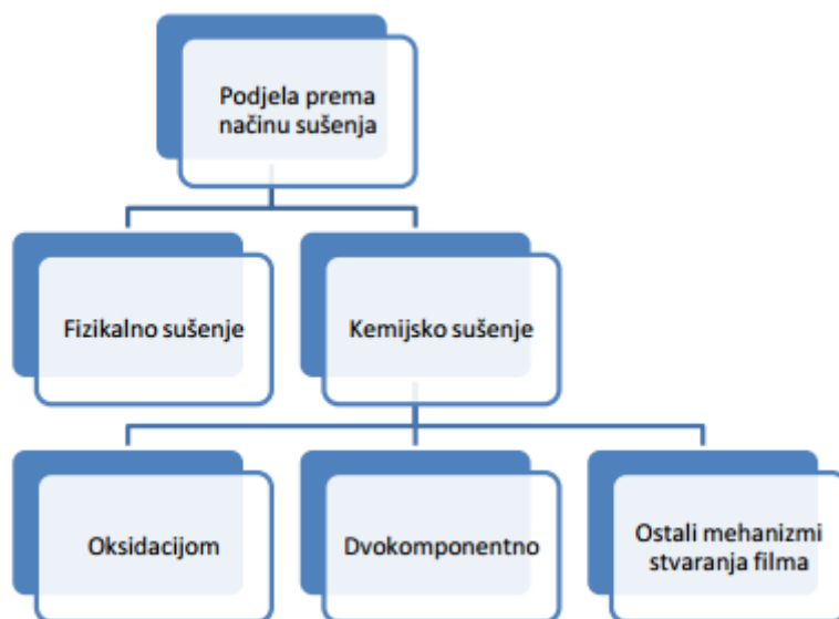
Slika 3. Podjela premaza prema načinu sušenja [5]
