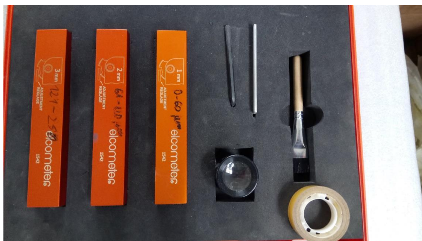
Slika 31. Oprema potrebna za izvođenje cross-cut testa
