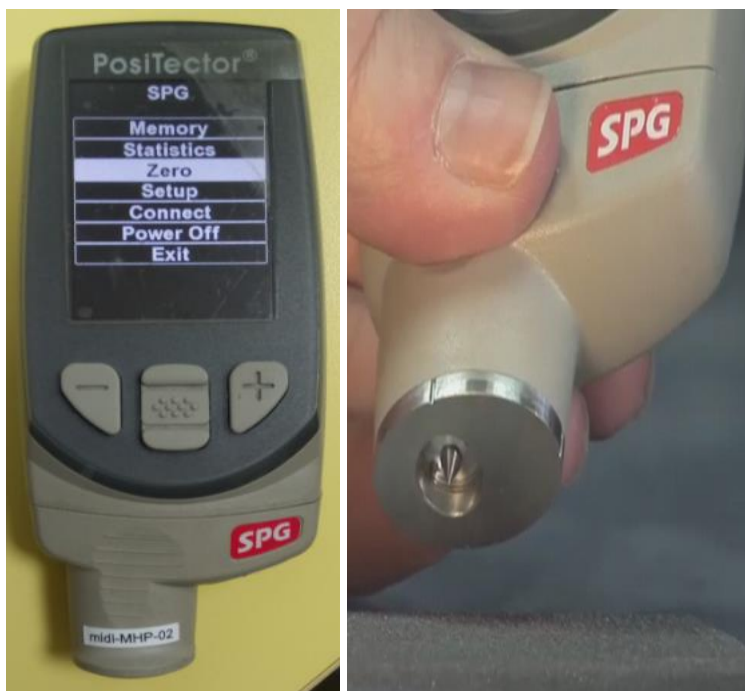
Slika 16. Uređaj za mjerenje hrapavosti PosiTector SPG
