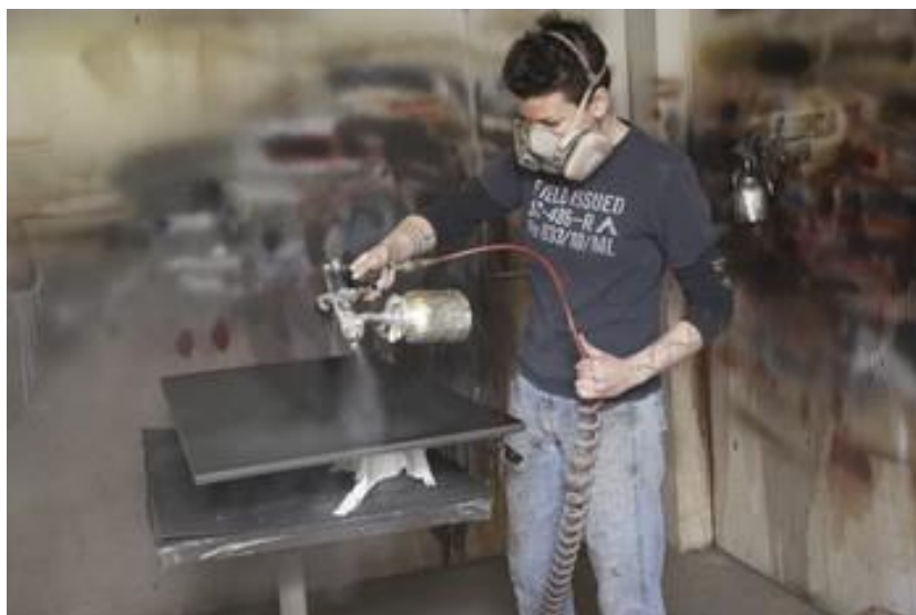
Slika 6. Nanošenje premaza zračnim štrcanjem [8]
