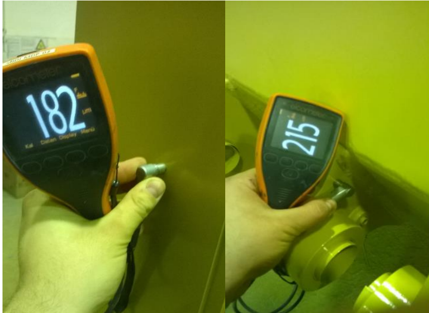
Slika 25. Mjerenje debljine suhog filma temeljnog premaza na šasiji MV-10
