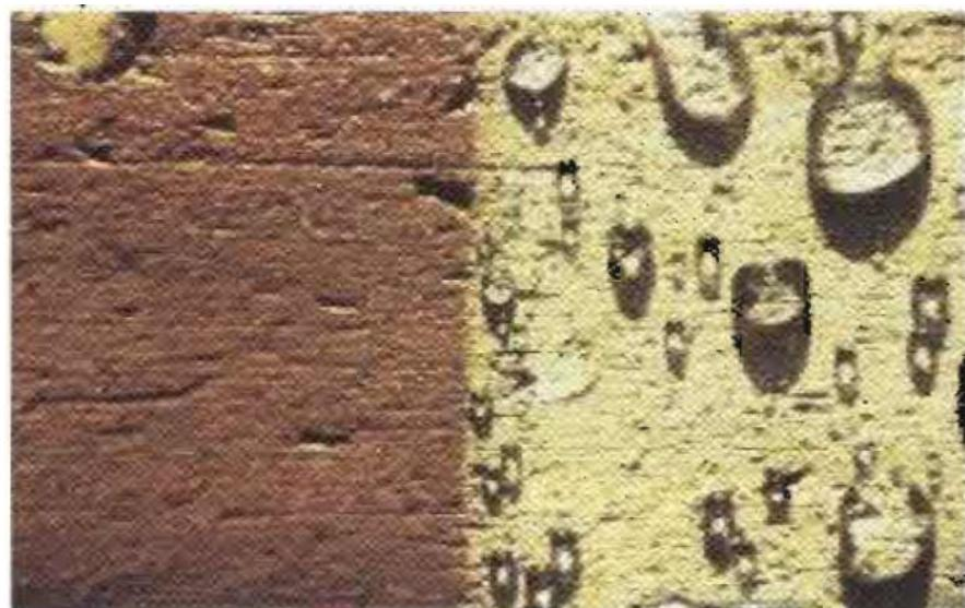
*Slika 4.12. Usporedba površine koja nije zaštićena i površine tretirane hidrofobnom impregnacijom*
