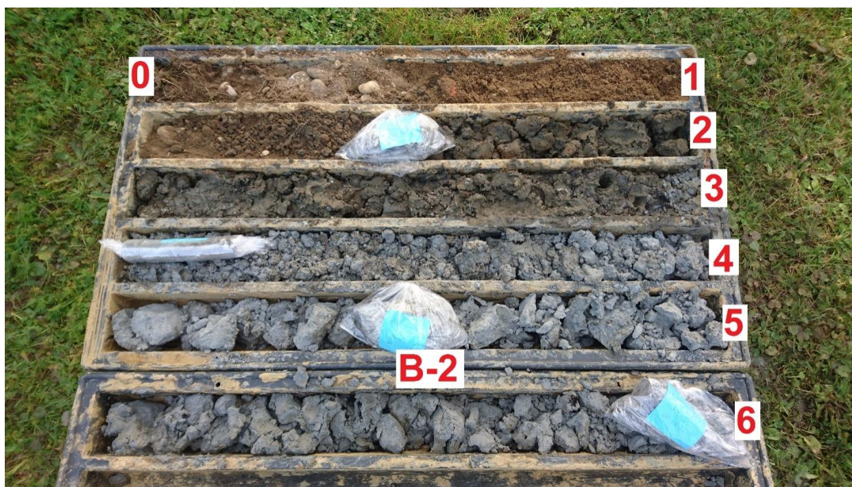
Slika 2.2. Spremanje poremećenog uzorka uzetog iz jezgre
