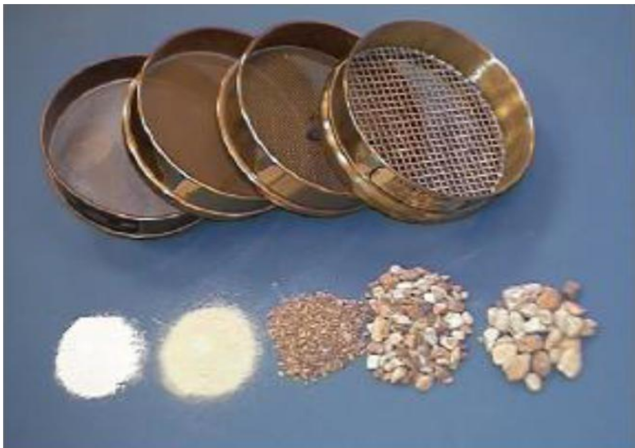
Slika 2. Primjeri sita različitih veličina otvora i različitih frakcija tla (postupak sijanja)
