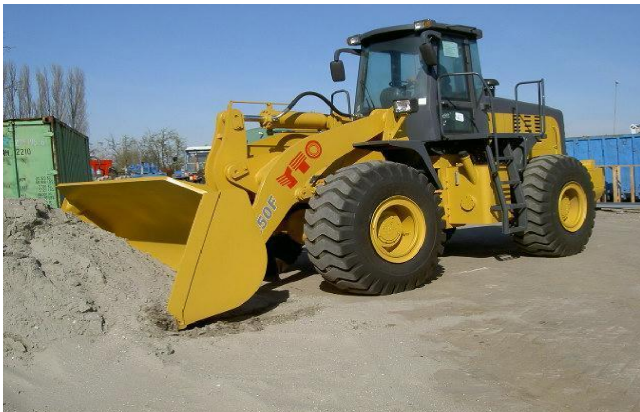
Slika 12. Utovarivač za utovar iskopanog materijala
