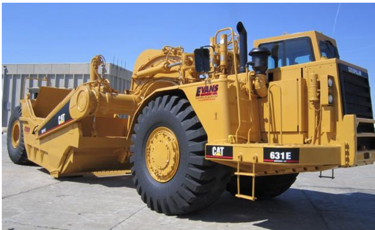
Slika 10. Skrejper za samoutovar, transport, istovar i razastiranje
