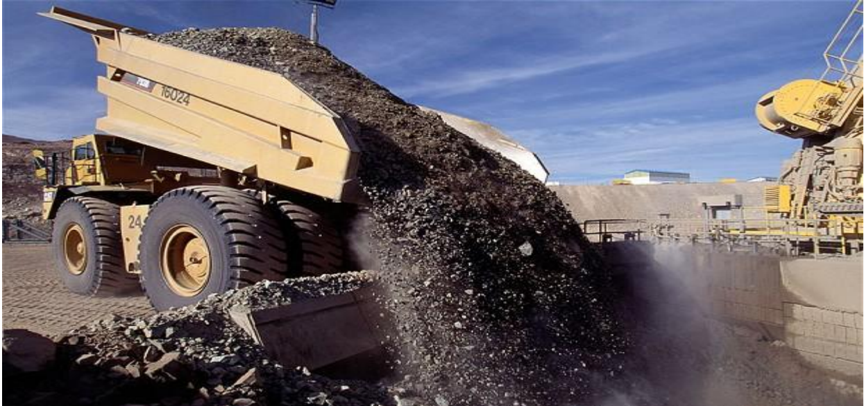
Slika 15. Odlaganje s grubim razastiranjem iz dampera
