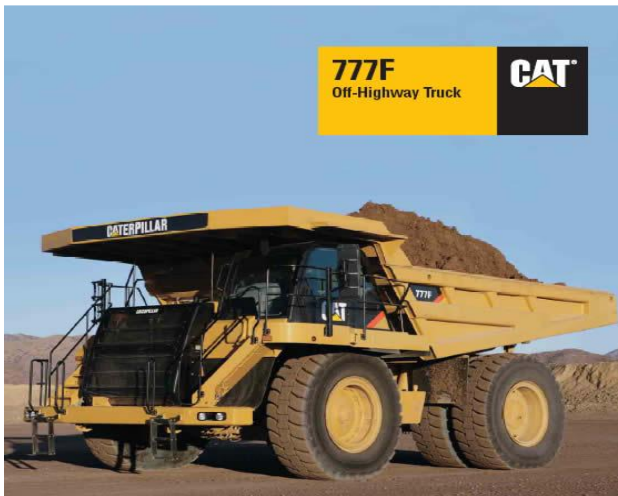
Slika 11. Damper za prijevoz sipkih materijala namijenjen gradilišnom prijevozu
