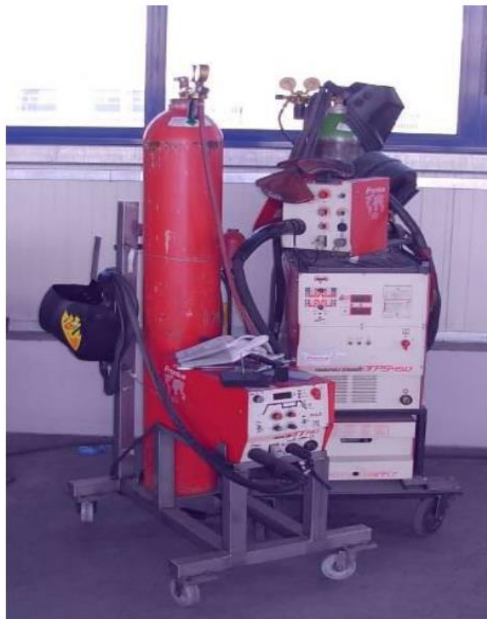
Slika 4.10. Aparat za zavarivanje [10]
