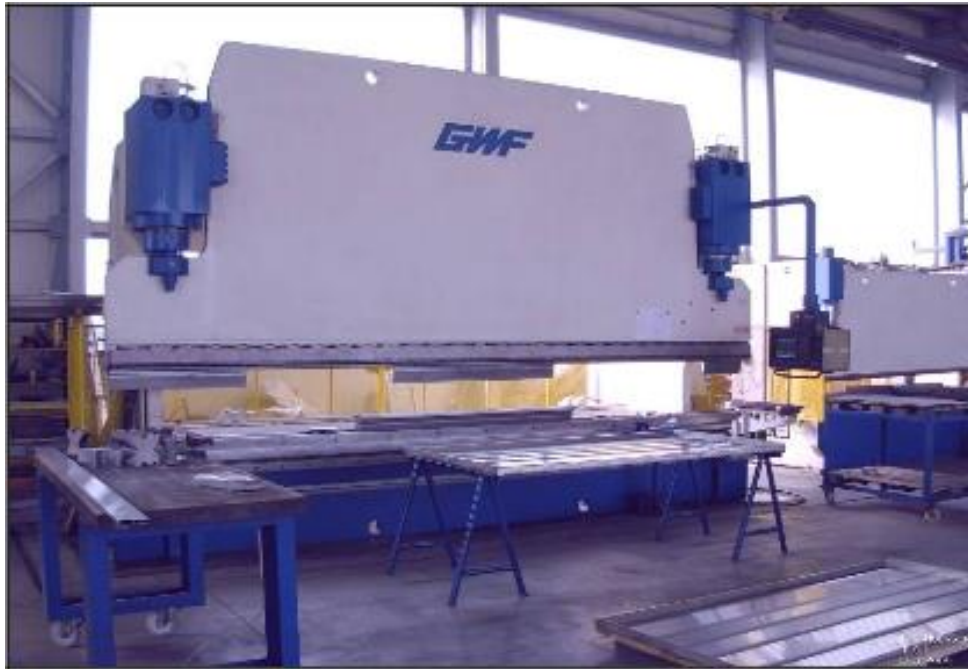
Slika 4.3. ABKANT preša za savijanje lima (veća) [10]
