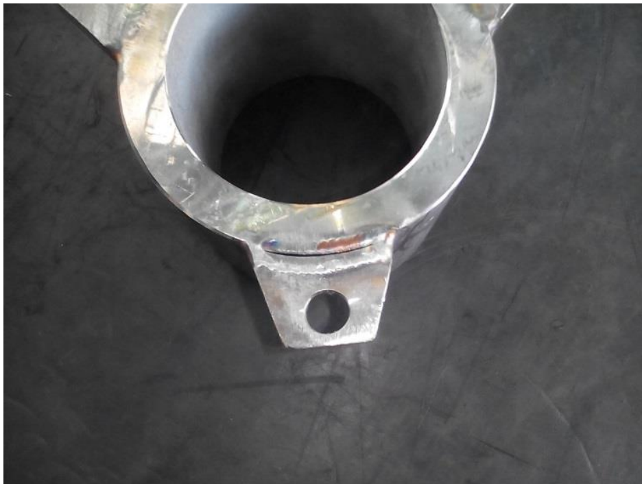
Slika 4.52. Greška kod zavarivanja – neprovareni korijen zavara
