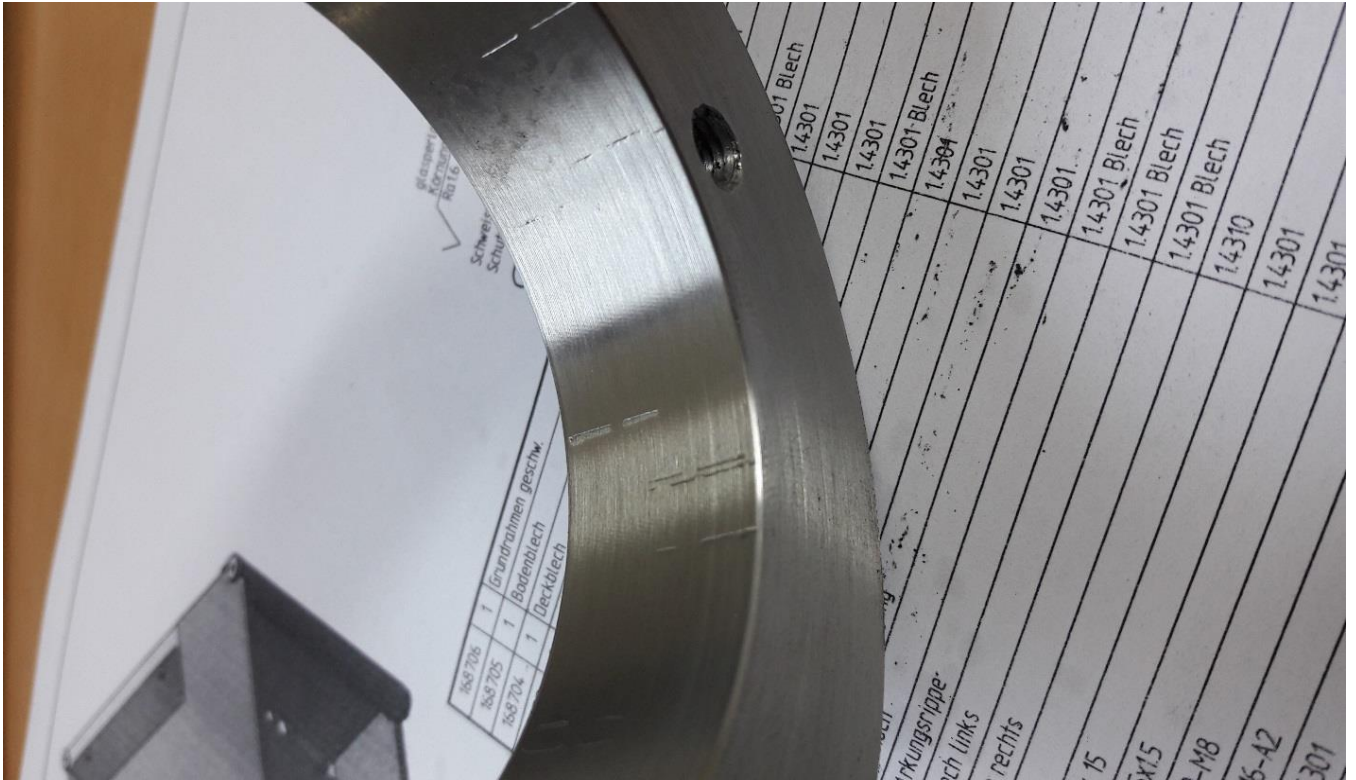
Slika 4.51. Oštećeni provrt pozicije
