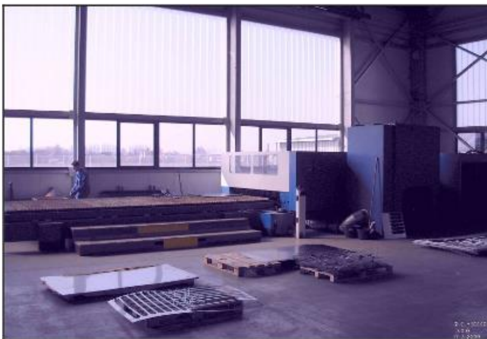
Slika 4.1. Stroj za lasersko rezanje lima [10]
