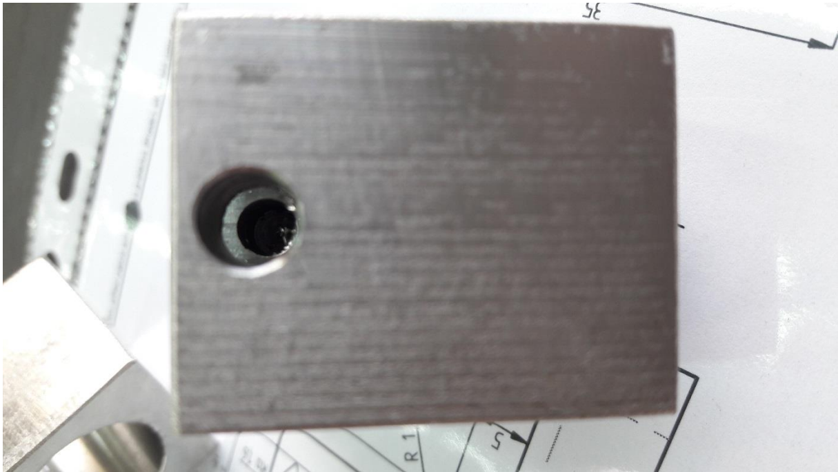
Slika 4.49. Pozicija bez izrađenog navoja na mjestu provrta (uvećano)
