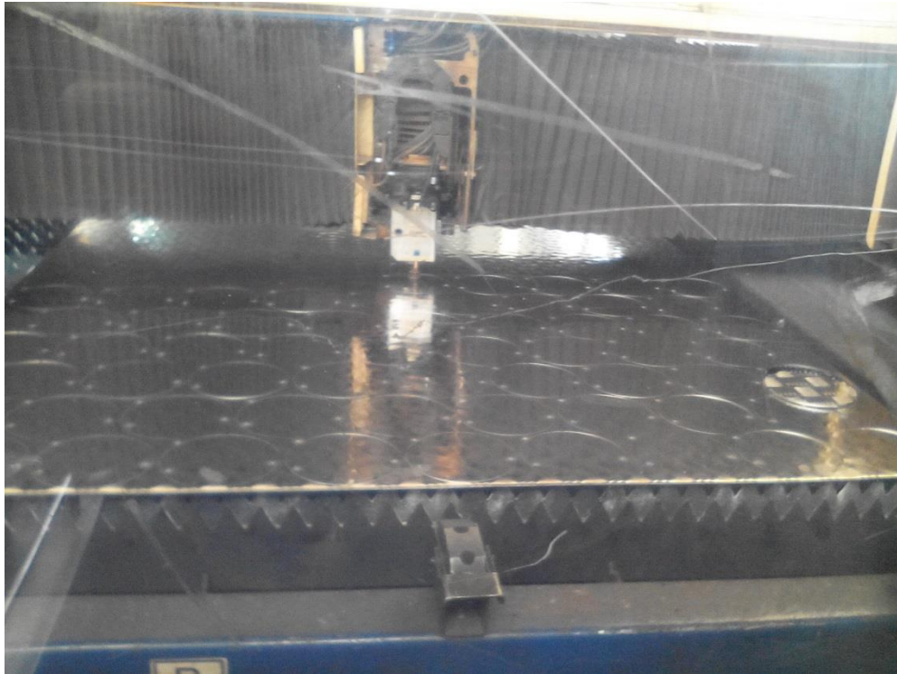
Slika 4.27. Stroj za lasersko rezanje lima u radu
