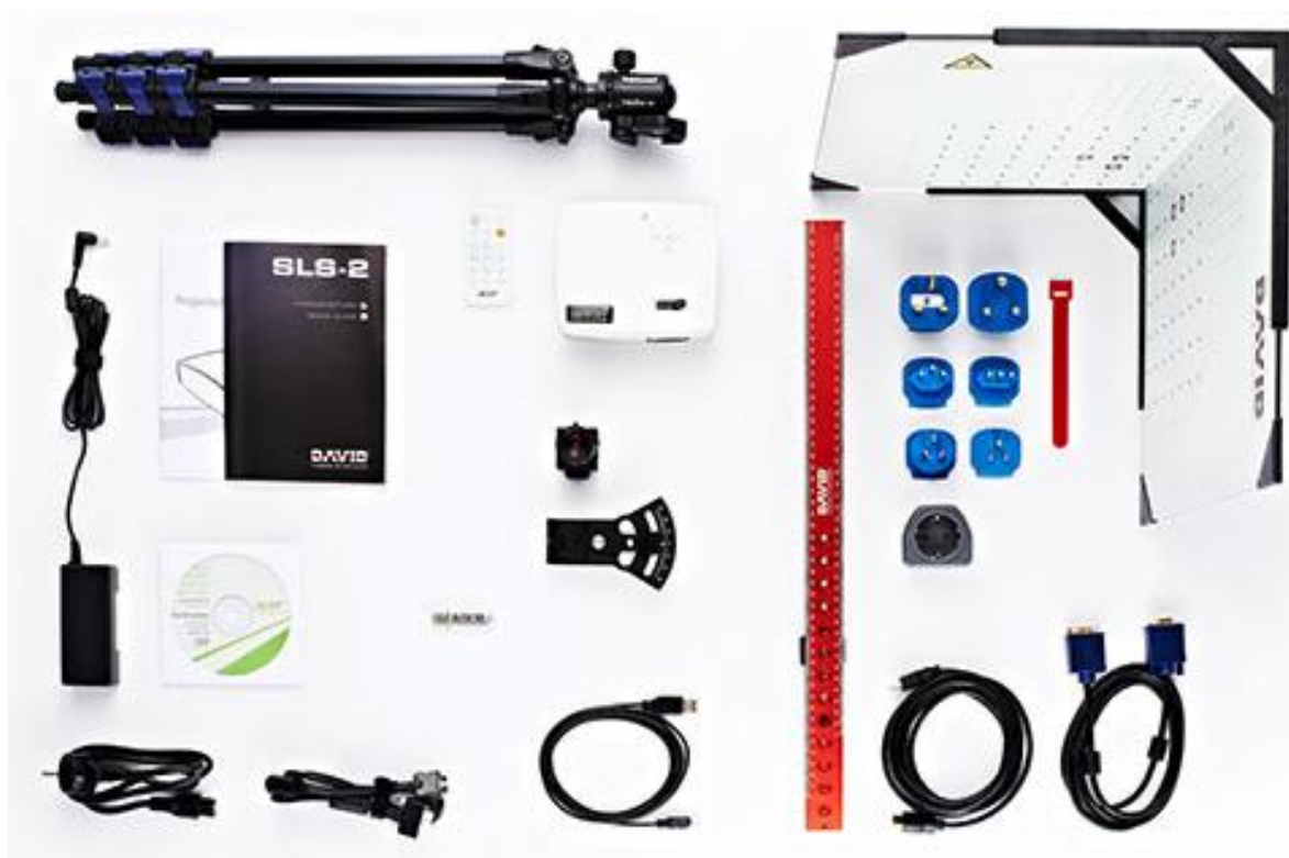
Slika 2.18 Dijelovi 3D skenera David SLS-2 [10]
