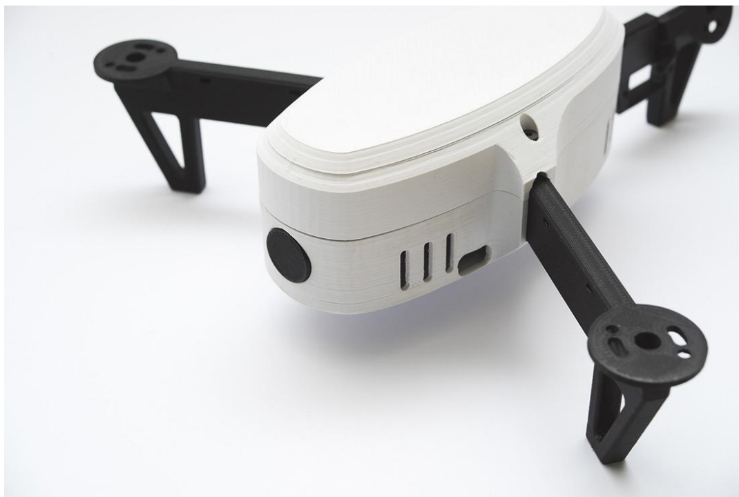
Slika 2.4 Dron izrađen FDM tehnologijom ispisa [2]
