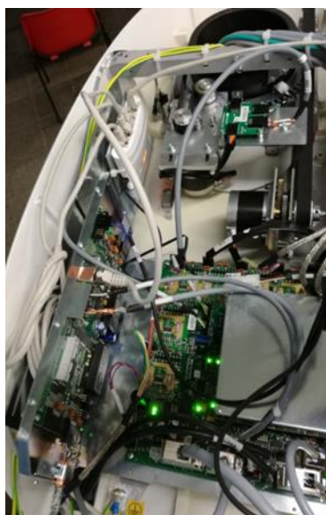
Slika 55 Elektronske ploče ispod poklopca uređaja (autor)
