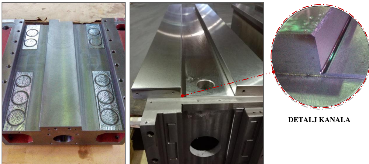
Slika 7.25: Križni suport (lijevo) i prizmatična izvedba stupa CNC glodalice (desno), sa detaljem kanala
