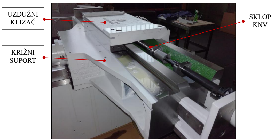
Slika 11.2: Križni suport sa montiranim klizačem uzdužne osi stroja
