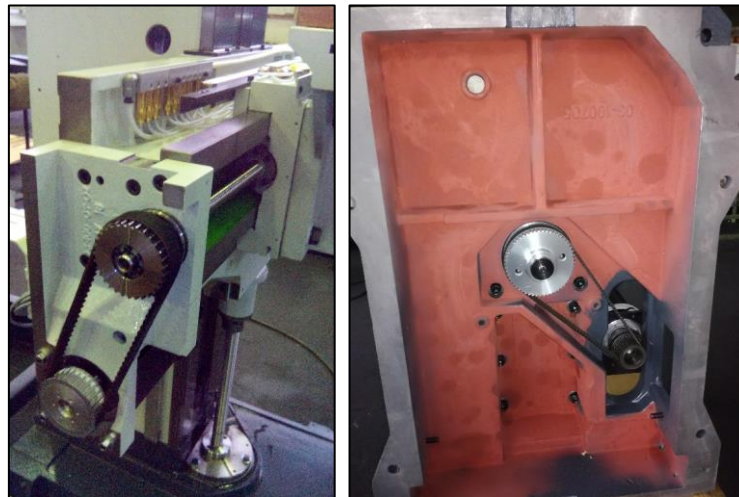
Slika 11.6 :Izvedba glavnog i posmičnog prigona CNC glodalice
