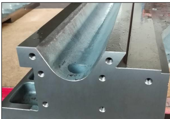
Slika 7.22: Kombinacija dva tipa vodilica suporta CNC glodalice (lijevo), Slika 7.23: Kompenzacijske klinaste letve za podešavanje zračnosti između vodilica AS (desno)
