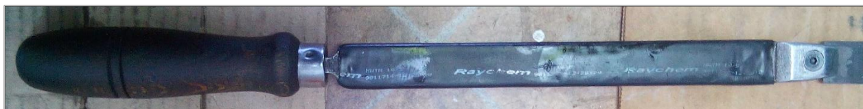
Slika 8.3: Grečalo sa oštricom od tvrdog metala
