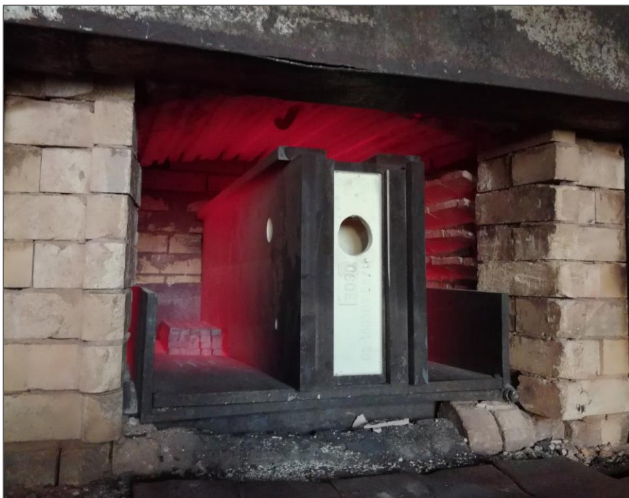
Slika 10.2: Hlađenje stupa stroja u otvorenoj peći nakon normalizacijskog žarenja
