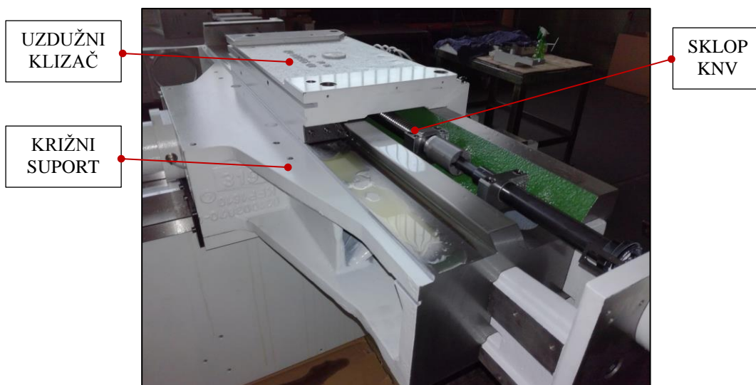
Slika 11.2: Križni suport sa montiranim klizačem uzdužne osi stroja
