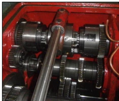
Slika 7.7: Prijenosnici glavnog prigona univerzalnog tokarskog stroja
