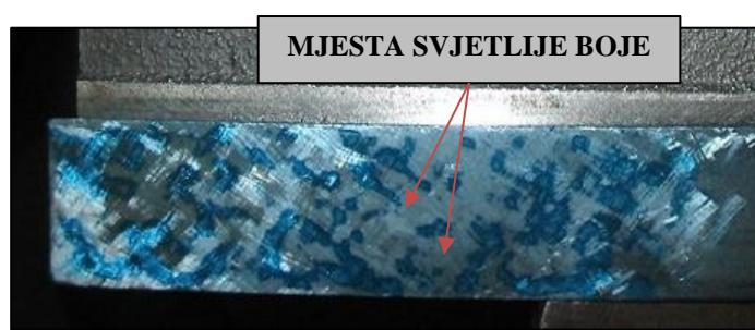
Slika 8.7: „Tuširana slika“ površine
