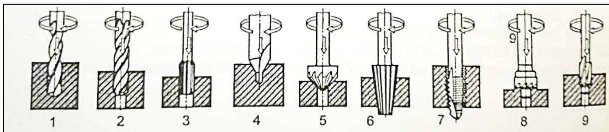
*Slika 5.11: Osnovne obrade i alati na bušilici [10]*
