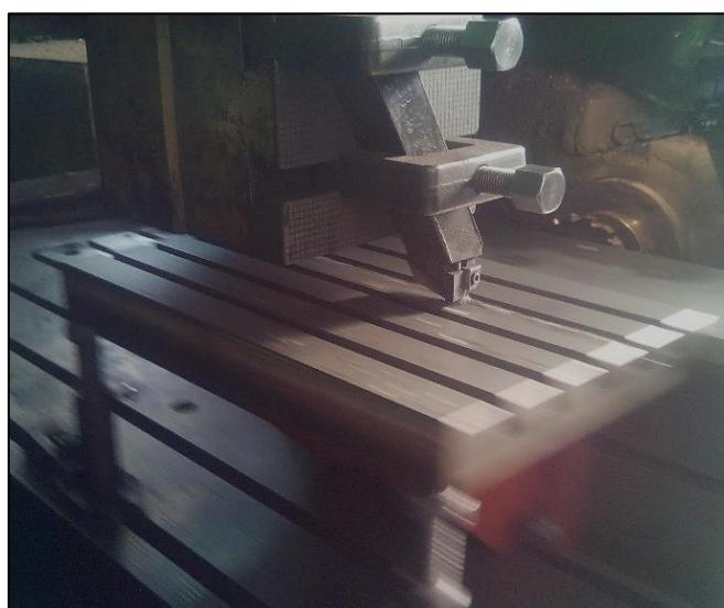
*Slika 5.13: Portalno (dugohodno) bljanje pritezne plohe radnog stola glodalice*
