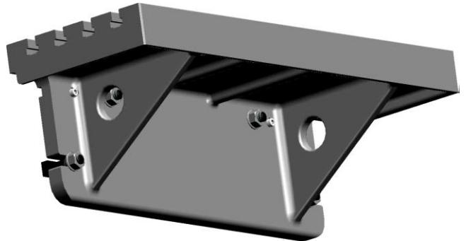
Slika 5.8: Radni stol glodalice
