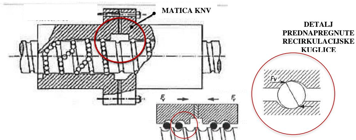
Slika 7.13: Izvedba prednaprezanja sa dvodijelnom maticom KNV [18]
