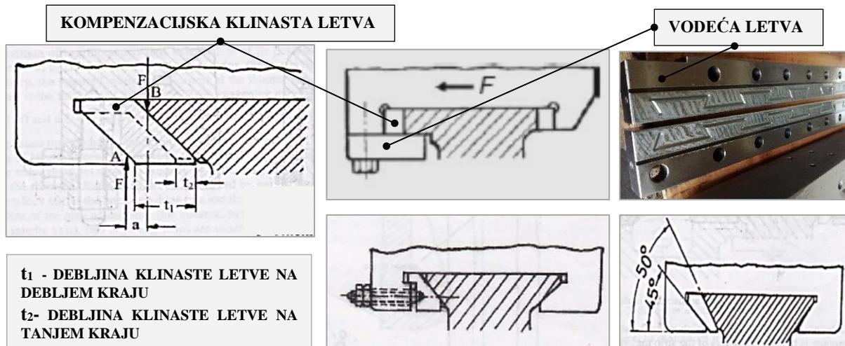
*Slika 7.24:Načini prednaprezanja vodilica korištenjem kompenzacijске i vodeće letve*
