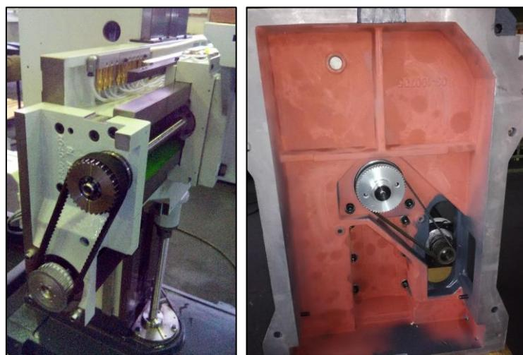
*Slika 11.6 :Izvedba glavnog i posmičnog prigona CNC glodalice*
