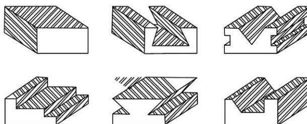
*Slika 5.6: Tipični izgled površina obrađenih operacijama glodanja [24]*
