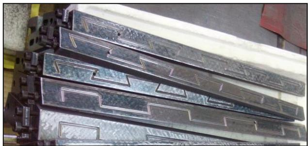
Slika 7.22: Kombinacija dva tipa vodilica suporta CNC glodalice (lijevo),
