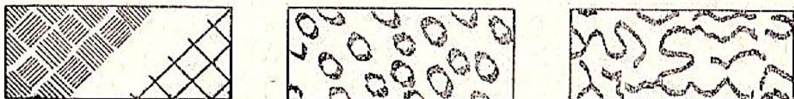
Slika 8.8: Tragovi obrade nakon grecanja („šare“)
