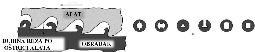
*Slika 5.14: Princip obrade iglom za provlačenje (lijevo),
