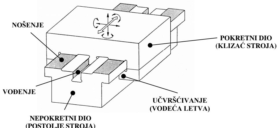
Slika 7.20: Funkcija kliznih površina vodilica stroja (klizne vodilice) [17]
