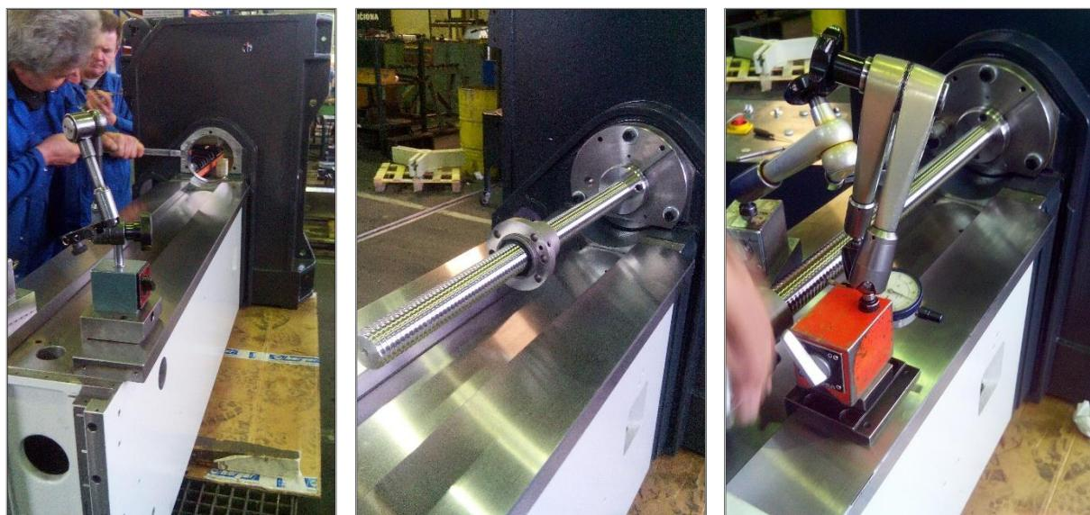
*Slika 11.1: Montiranje i podešavanje vertikalnog KNV*
