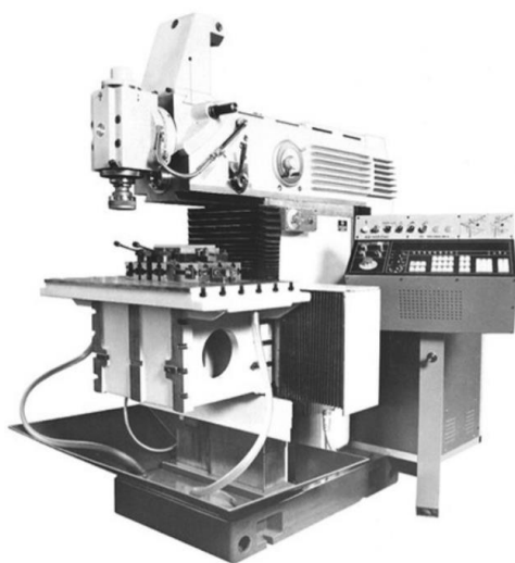
Slika 2.4: Numerički upravljana glodalica „AG-400 CNC“, proizvodnja Prvomajska TAS Zagreb
