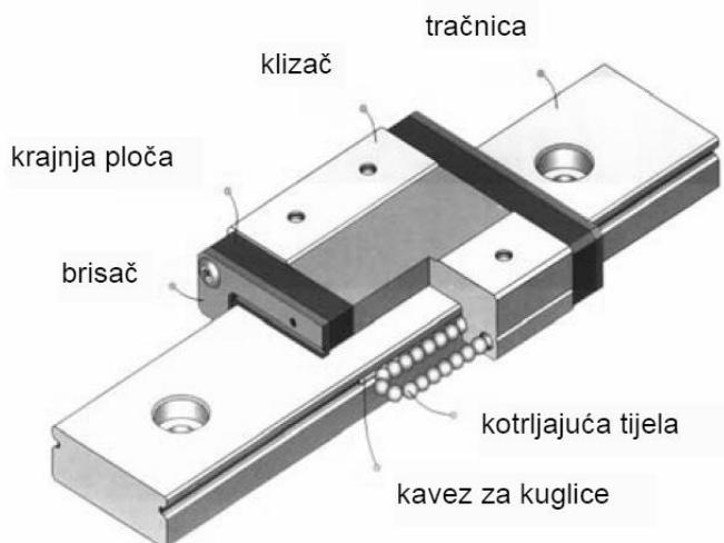
Slika 7.28: Kotrljajuća vodilica sa označenim dijelovima [17]
