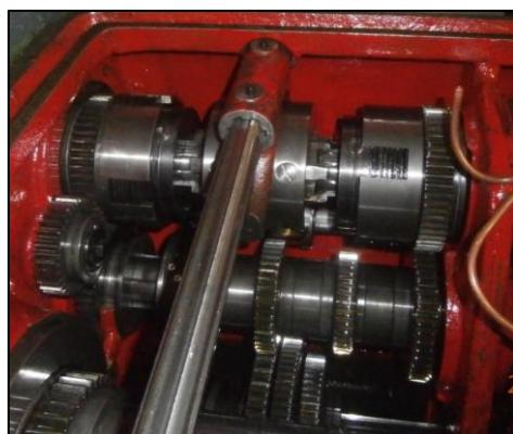
*Slika 7.7: Prijenosnici glavnog prigona univerzalnog tokarskog stroja*
