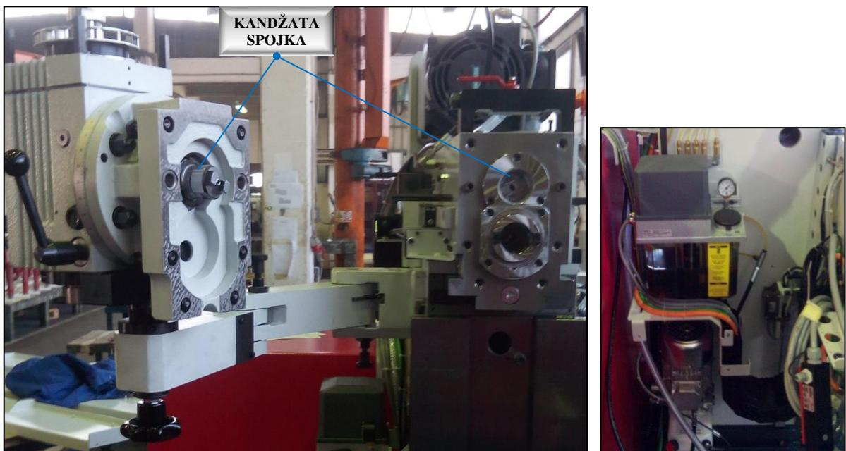
*Slika 11.4: Postavljanje vertikalne zakretne radne glave (lijevo), spremnik ulja sa crpkom (desno)*
