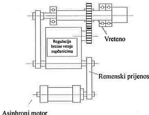
*Slika 7.6: Prigon kod klasičnih alatnih strojeva [18]*
