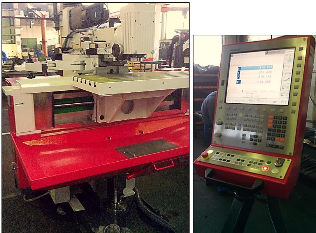
*Slika 11.7: CNC glodalica sa upravljačkom jedinicom stroja*
