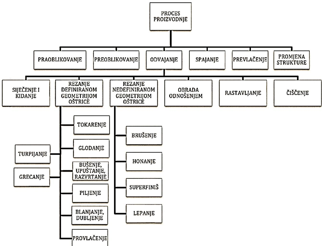
*Slika 4.1: Podjela postupaka proizvodnje prema DIN 8580*
