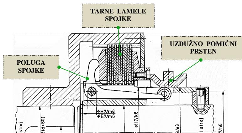
Slika 7.18: Tarna višelamelna spojka s mehaničkim uključivanjem
