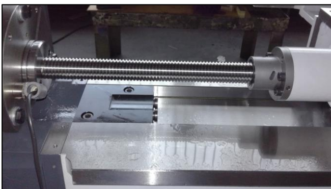
Slika 7.11: Kuglično navojno vreteno „Z“ osi
