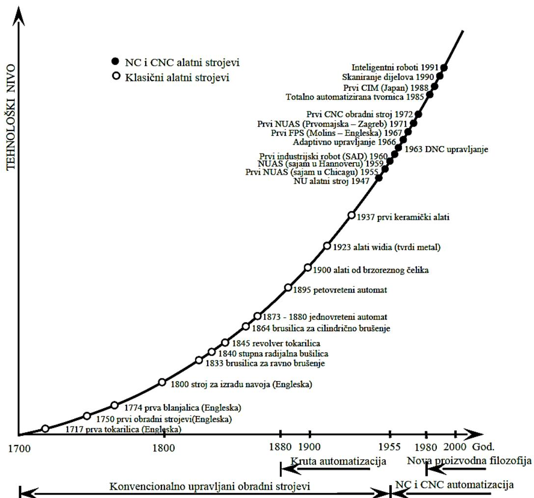
Slika 2.2: Razvoj obradnih i proizvodnih sustava [4]
