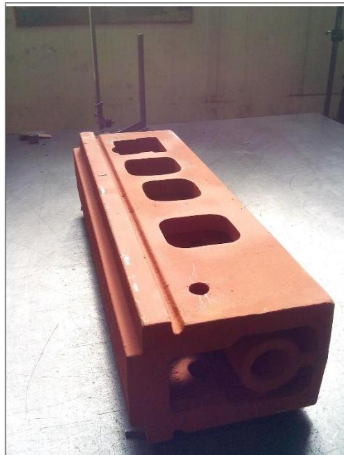
*Slika 8.10: Odljevak vreteništa stroja iz SL na stolu za označavanje*
