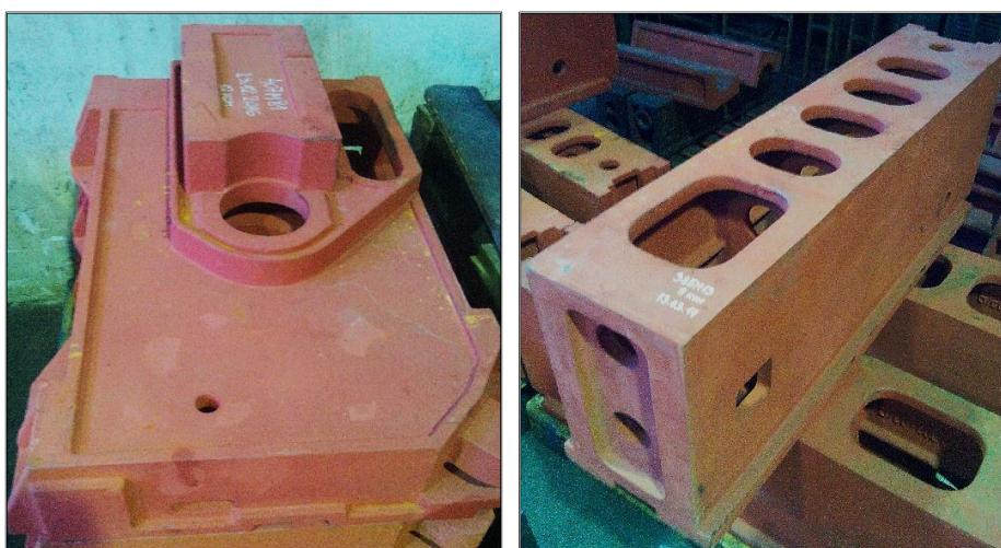
*Slika 9.1: Odljevci nosivih dijelova konstrukcije alatnog stroja*
