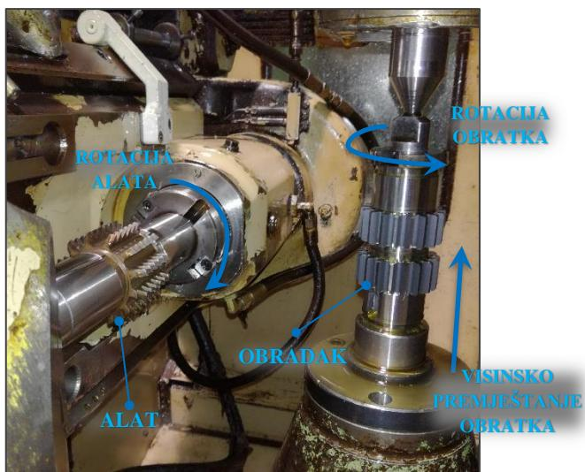
Slika 5.16: Stroj za odvalno glodanje zupčanika Pfauter postupkom
