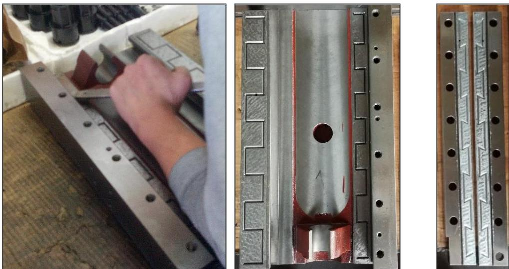
*Slika 8.2: Grecanje kliznih površina; klizaća stroja (lijevo) i vodećih letvi (desno)*
