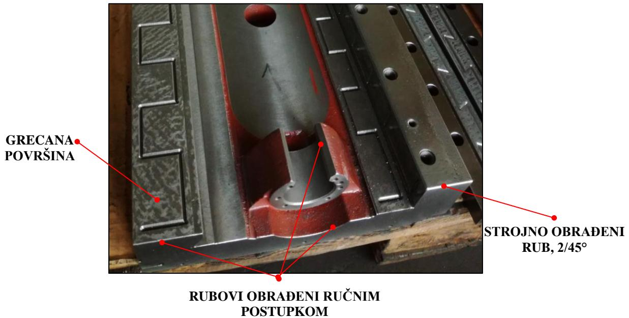
*Slika 8.1: Operacije ručne obrade na uzdužnom klizaču stroja*
