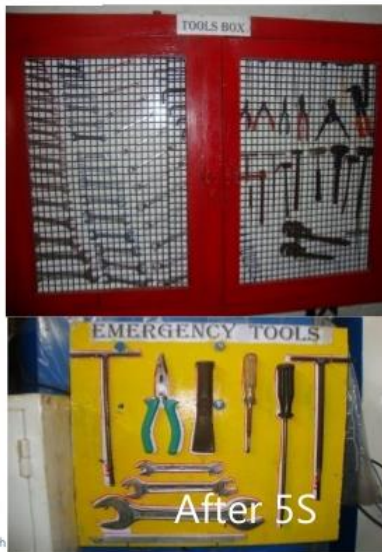
Slika 2.8. Spremište alata prije i poslije 5S implementacije [8]
