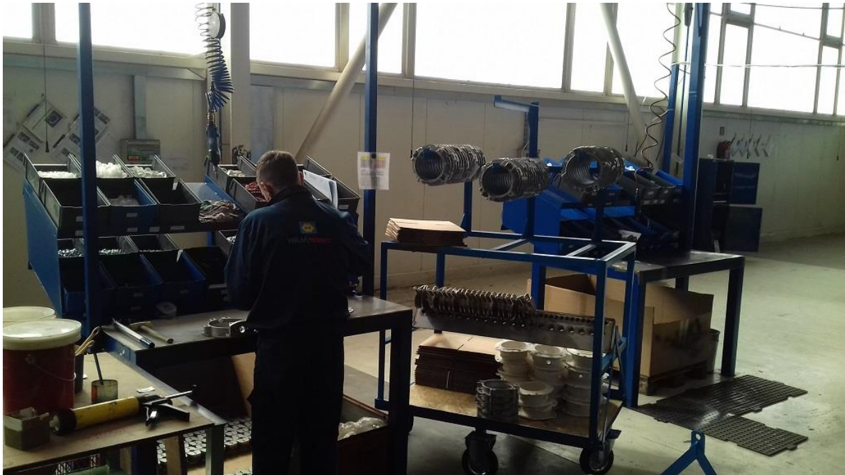
Slika 3.14. Montaža leptirastih ventila na montažnom stolu „komad po komad“ (poslije) [28]
