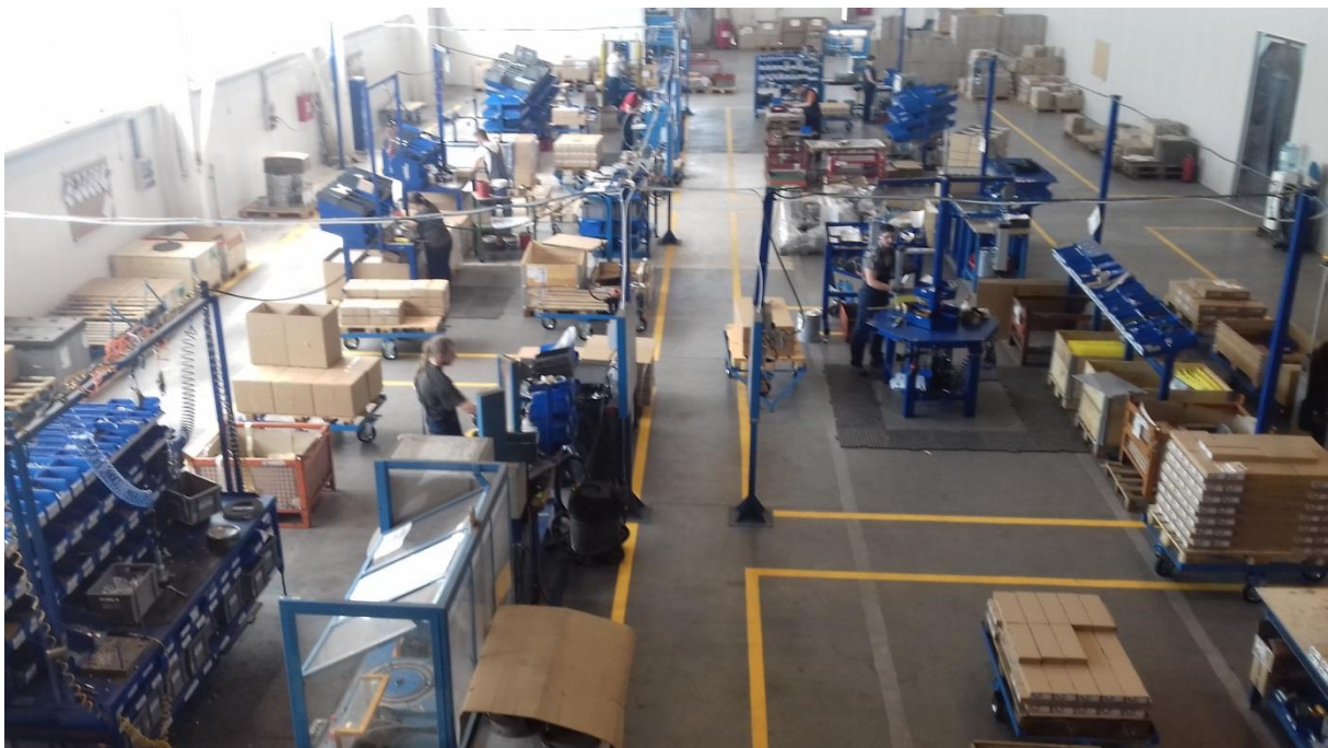
Slika 3.12. Fotografija rasporeda proizvodnih linija montaže ventila nakon reorganizacije [28]
