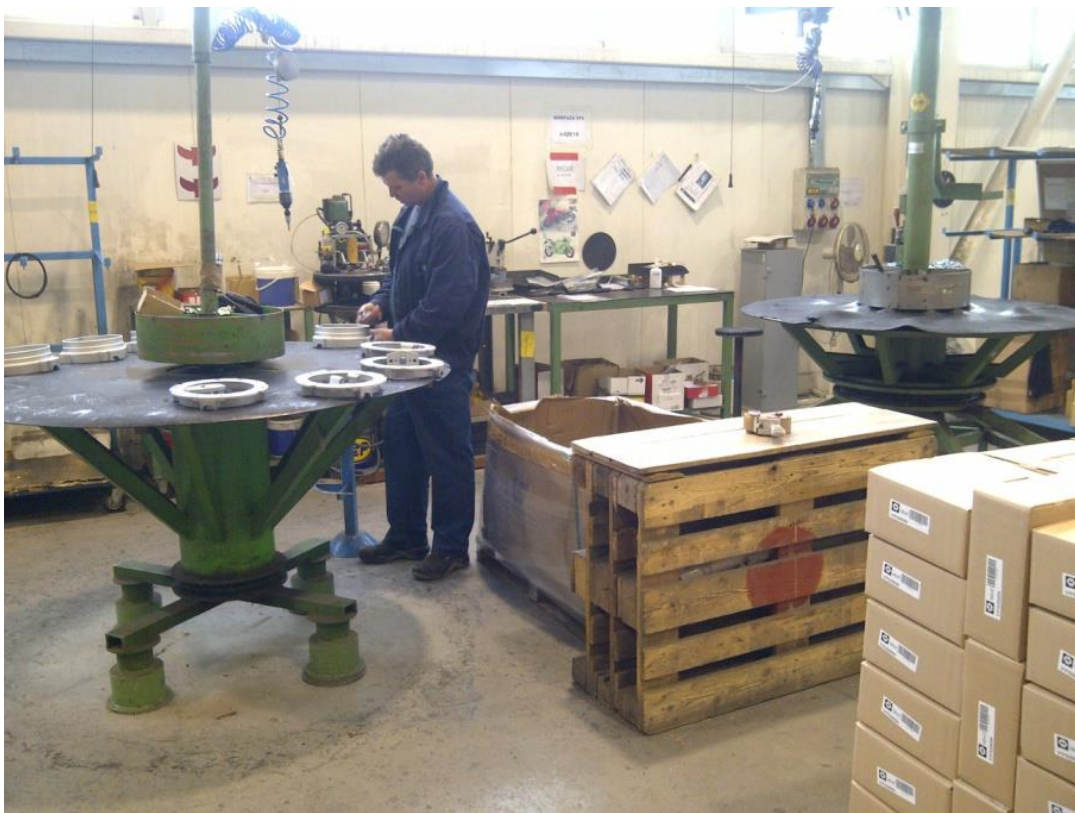
Slika 3.13. Montaža leptirastih ventila na rotacionom montažnom stolu (prije) [28]
