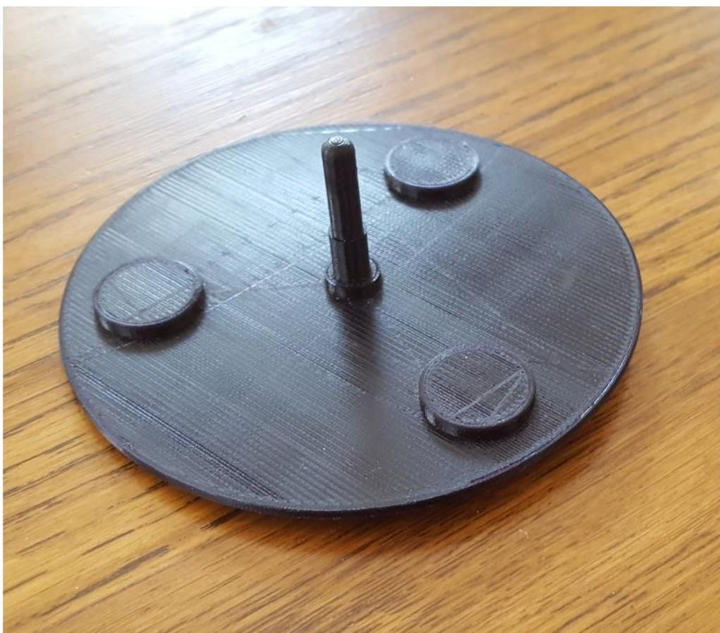
Slika 6.4. Izgled prototipa rotora s gornje strane
