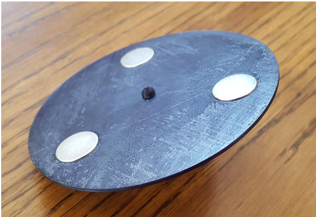
Slika 7.6. Princip spajanja neodimijskih magneta s prototipom rotora
