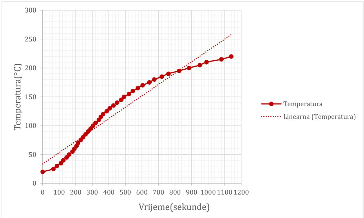
Grafikon 2 – Promjena temperature grijanog prostora uređaja u ovisnosti s vremenom uz sve zatvorene strane grijanog prostora
