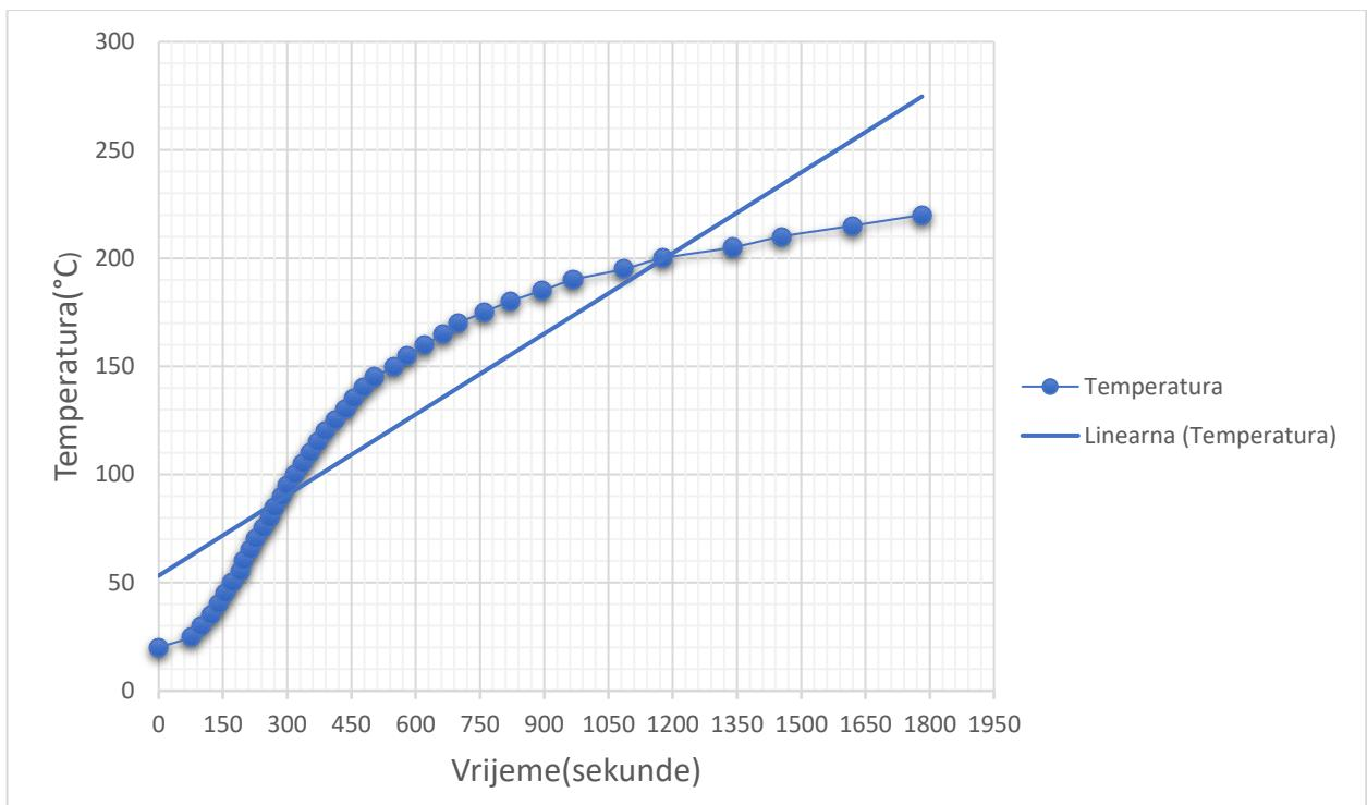
Grafikon 1 – Promjena temperature grijanog prostora uređaja u ovisnosti s vremenom
