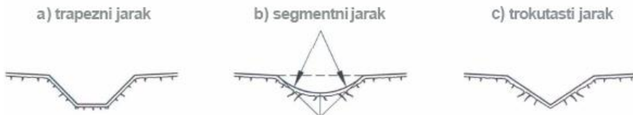
Slika 4.1: Poprečni presjeci jaraka (Rezo, 2016.)
