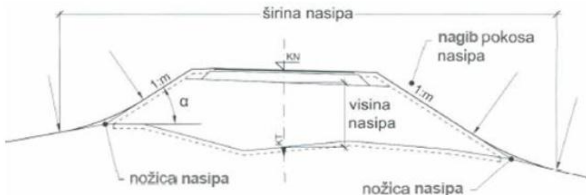
Slika 7.6: Shema nasipa (Rezo, 2013)
