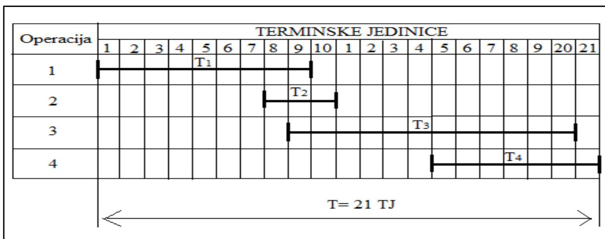
*Slika 4.8. Primjer vođenja paralelnog ciklusa proizvodnje primjenom gantograma*
