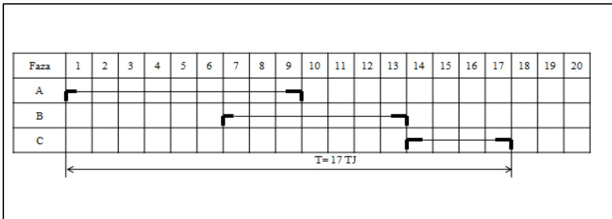
*Slika 4.4. Primjer gantograma za neku određenu radnu operaciju*
