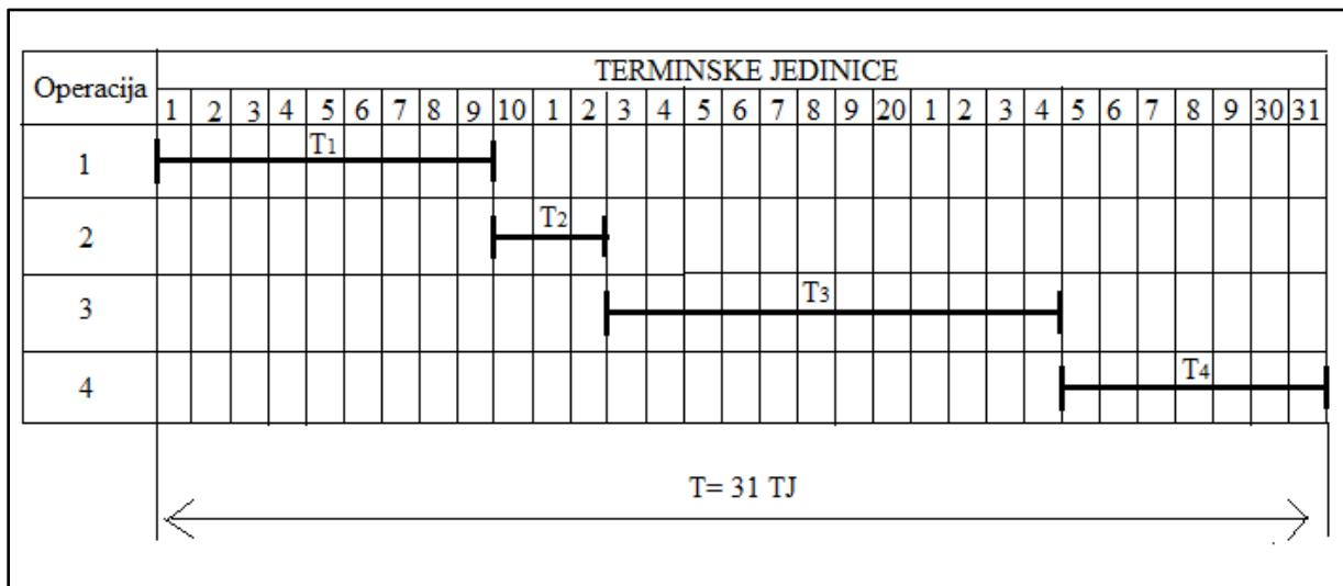
*Slika 4.7. Primjer vođenja postepenog ciklusa proizvodnje primjenom gantograma*
