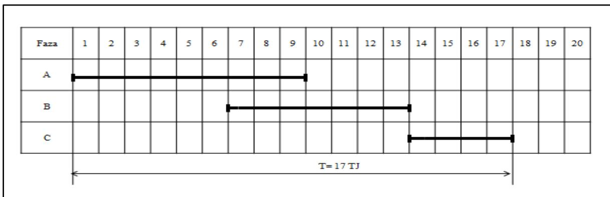
*Slika 4.5. Primjer vođenja gantograma, s podebljanom linijom označavanja*
