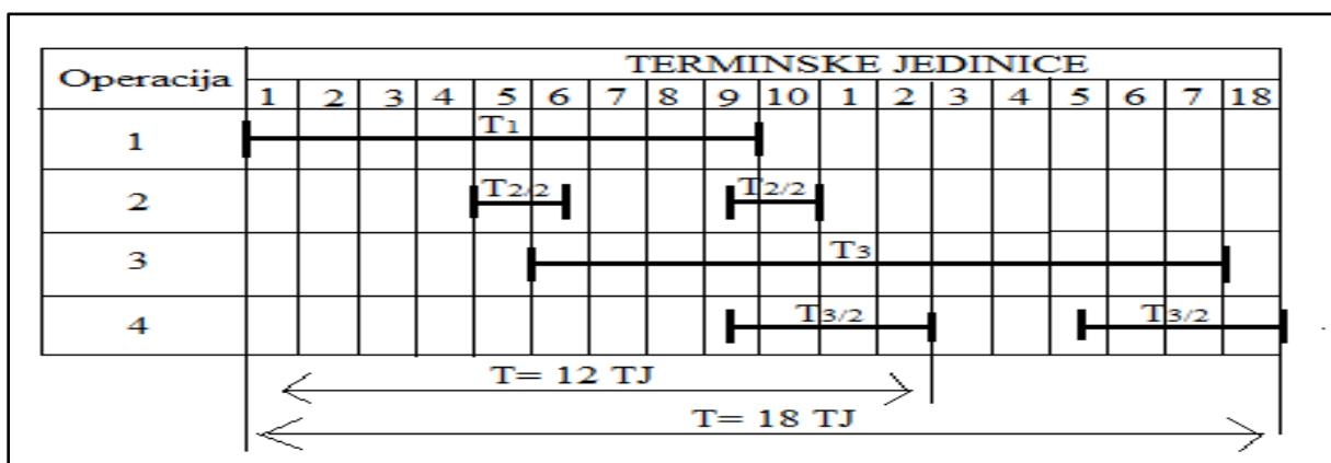
Slika 4.9. Primjer vođenja kombiniranog ciklusa proizvodnje primjenom gantograma
