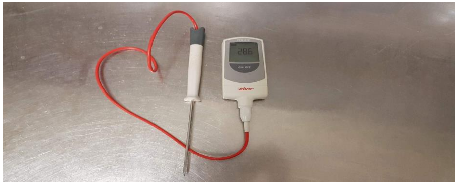
Slika 4.4.3. Ubodni termometar za mjerenje temperature kod pripreme jela od mesa
