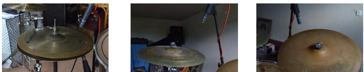
Slika 17 Pozicije mikrofona kod snimanja nožne, vodeće i rasprskavajuće činele
