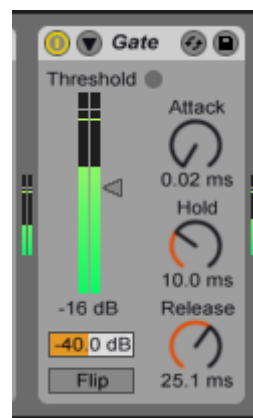
Slika 20 Lijevo: pozicioniranje overhead mikrofona, desno: gate obradnik
