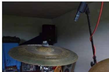
Slika 17 Pozicije mikrofona kod snimanja nožne, vodeće i rasprskavajuće činele
