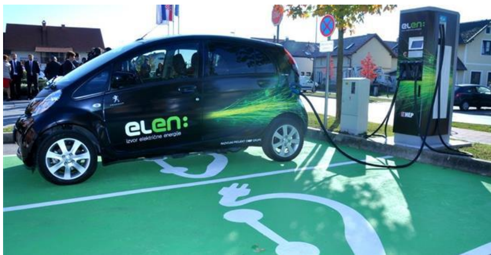
Slika 2.6. Prikaz konduktivnog punjenja EV [2]
