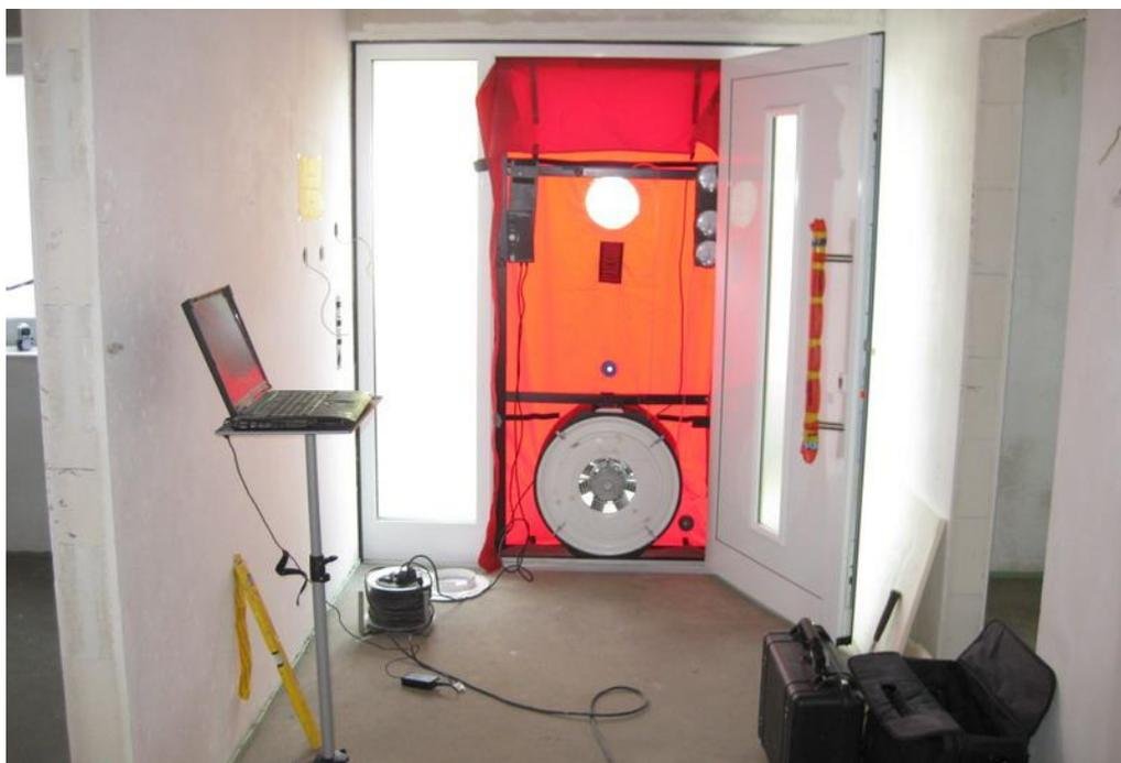
*Slika 4.5.1. Ispitivanje blower door testom*
