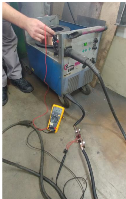
Slika 17. Mjerenje jakosti struje zavarivanja
