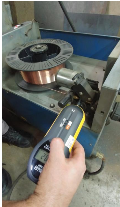
Slika 18. Mjerenje brzine žice
