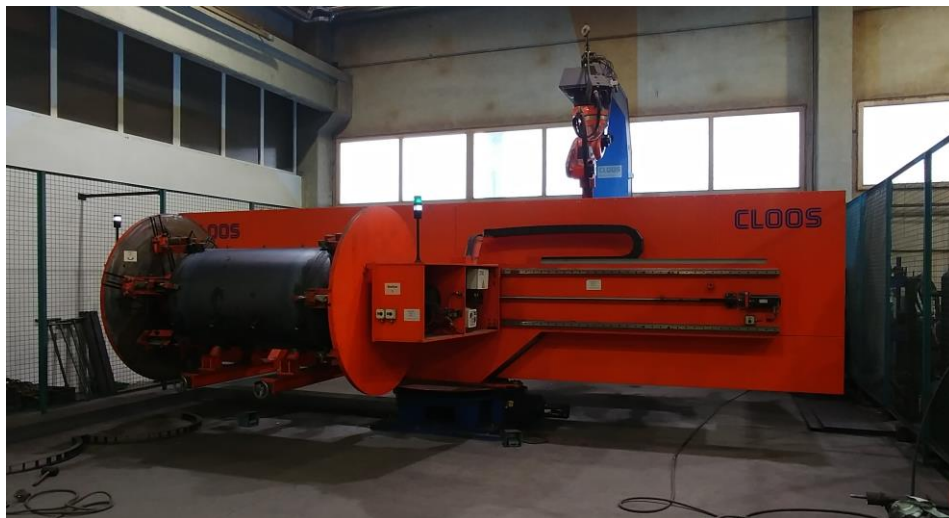
Slika 6. Robot za zavarivanje akumulacijskih spremnika
