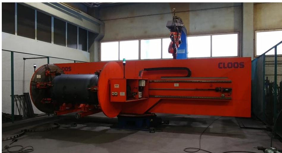
Slika 6. Robot za zavarivanje akumulacijskih spremnika
