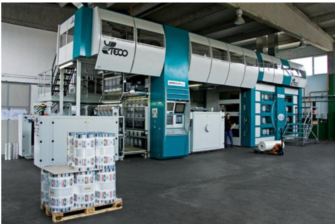
Slika 2.19 Osmerobojni fleksografski stroj s centralnim cilindrom
