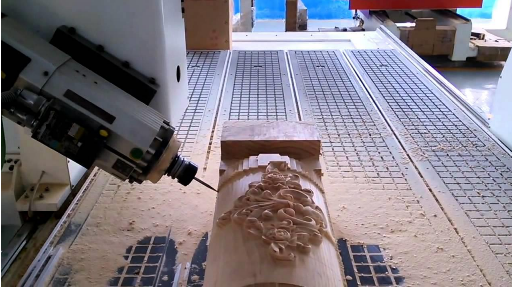
Slika 14. Petoosna obrada u drvenoj industriji [8]
