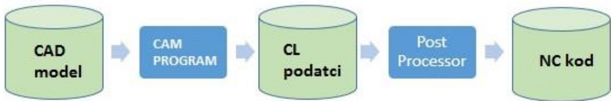
Slika 28. Mjesto postprocesora kod obradnog stroja
