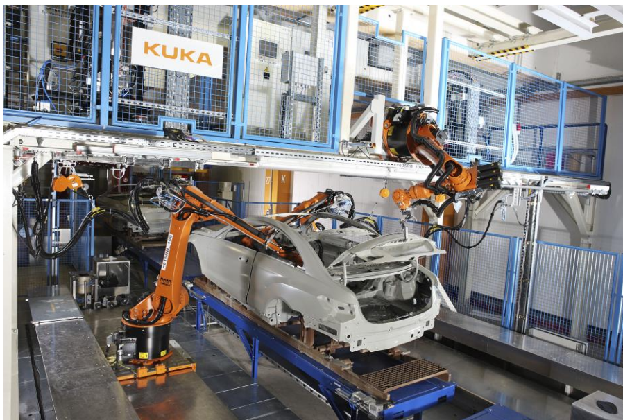
Slika 5. FMS sustav u automobilske industriji [3]
