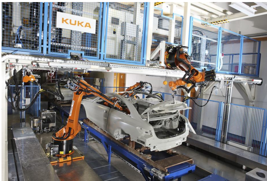
Slika 5. FMS sustav u automobilske industriji [3]
