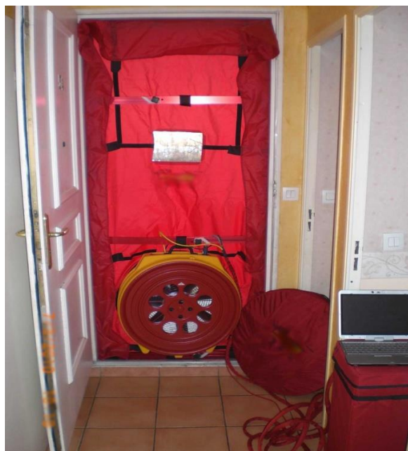
Slika 21. Prikaz blower door metodom testiranja
