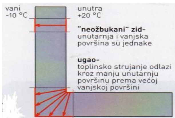
Slika 18. Princip djelovanja geometrijskog toplinskog mosta
