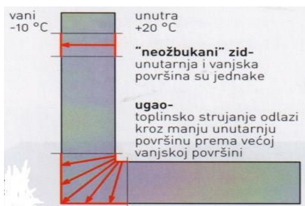
Slika 18. Princip djelovanja geometrijskog toplinskog mosta
