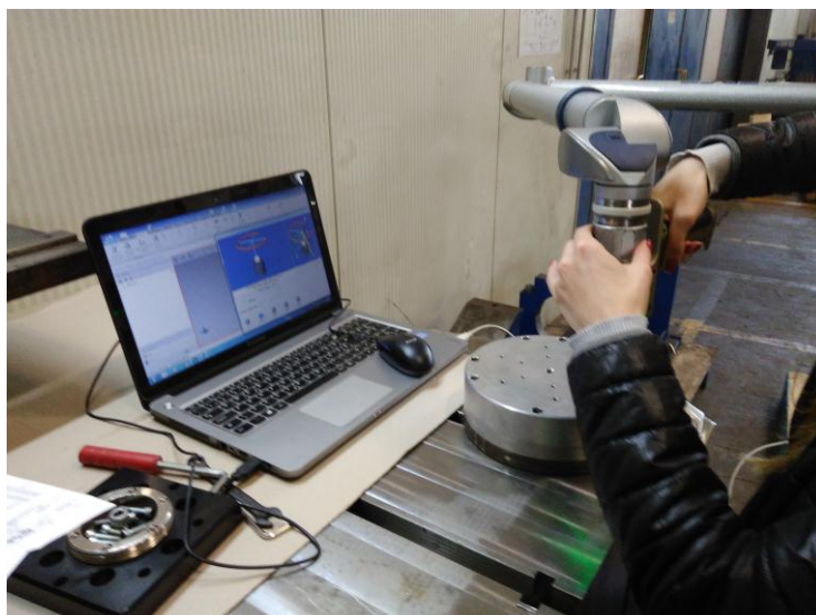
Slika 26. Kalibracije iz 3 različite pozicije [2]
