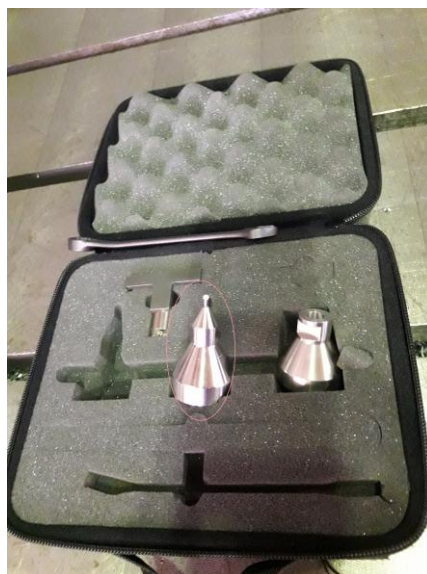
Slika 43. Ticalo (promjer kugle 6 mm) pomoću kojeg mjerimo
