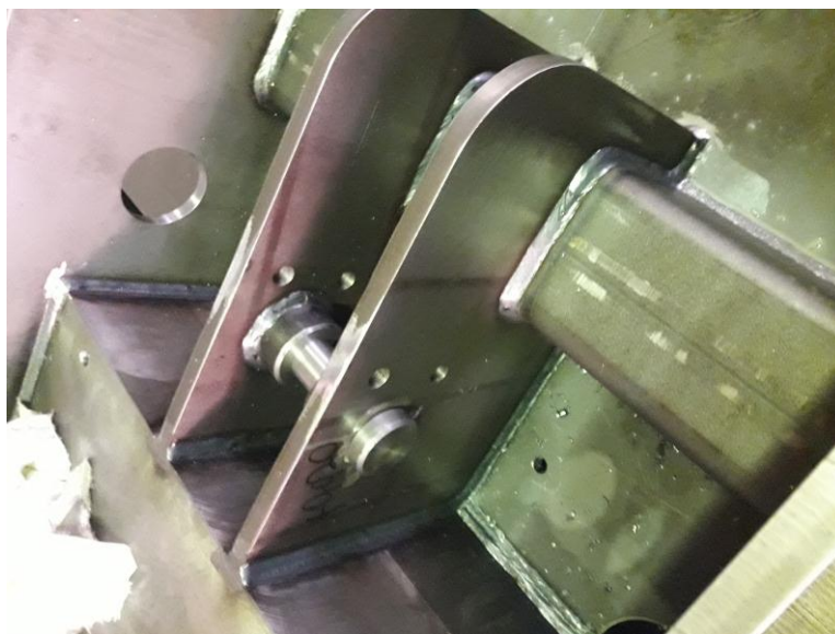
Slika 34. Kontrola mjerenja pomoću kalibra
