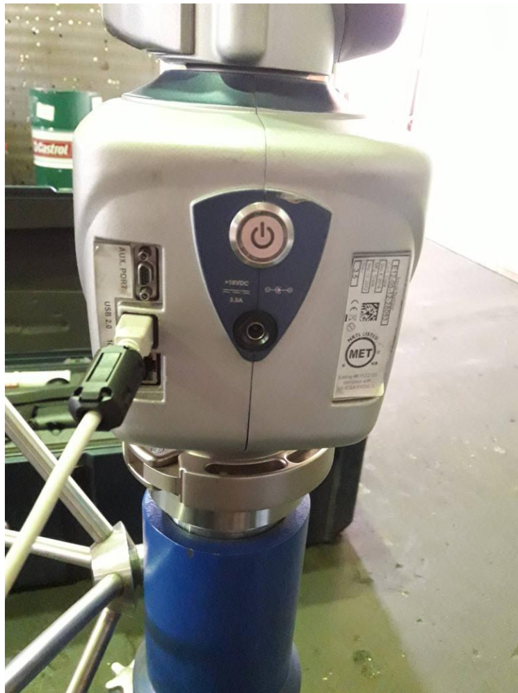
Slika 18. Mjesto paljenja Faro ruke i spajanja USB kabla [2]
