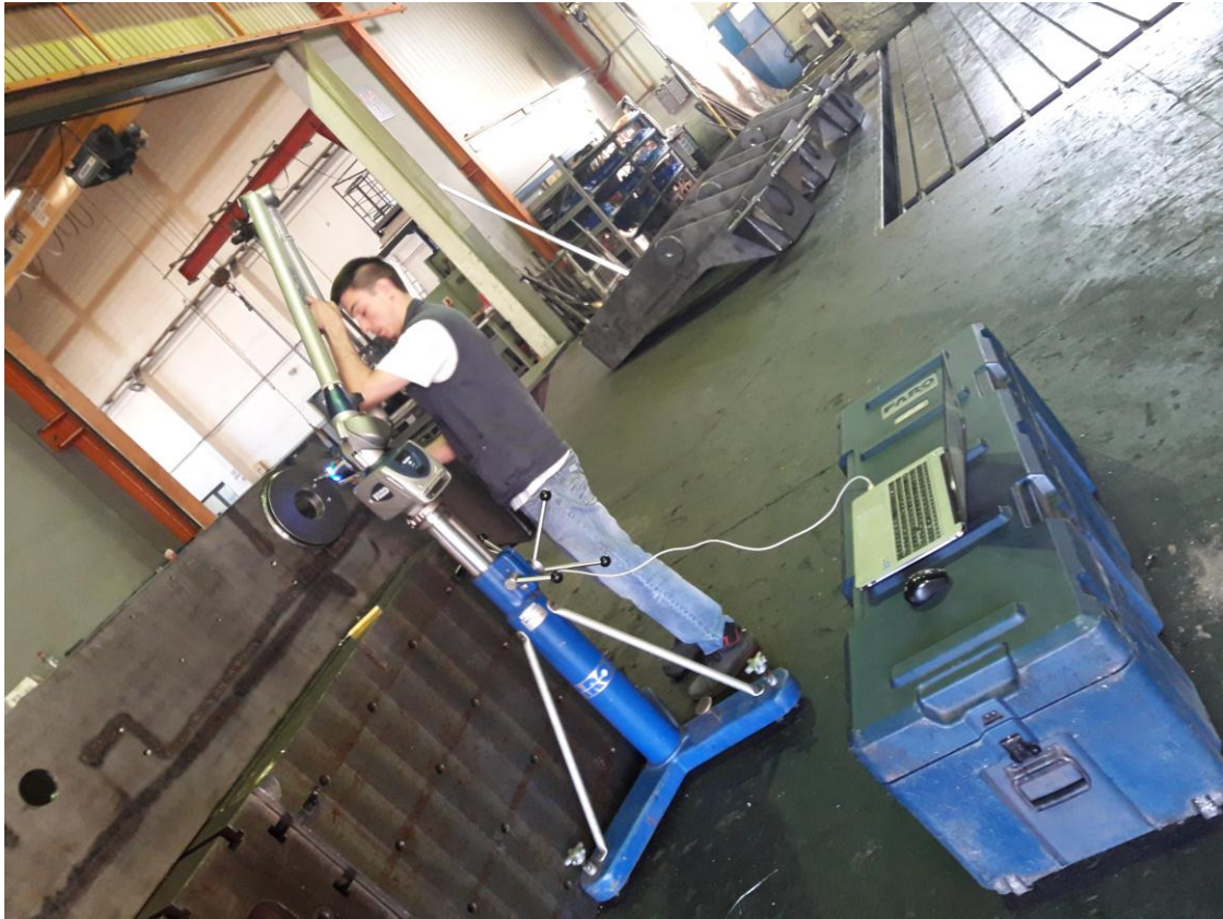
Slika 35. Mjerenje pomoću Faroruke
