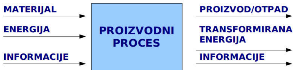
Slika 2.1 Shematski prikaz proizvodnog procesa [3]
