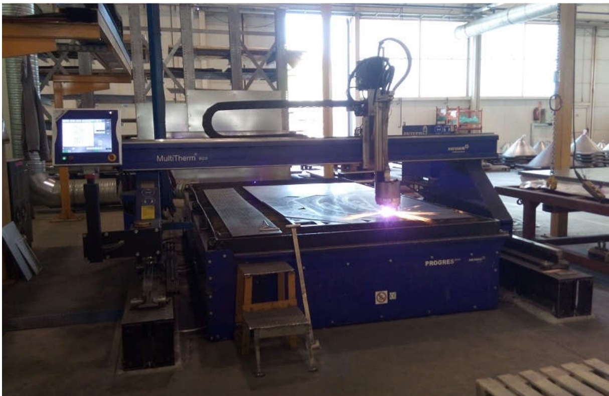
Slika 3.6 CNC plazma rezačica Hypertherm HPRXD 260 [27]
