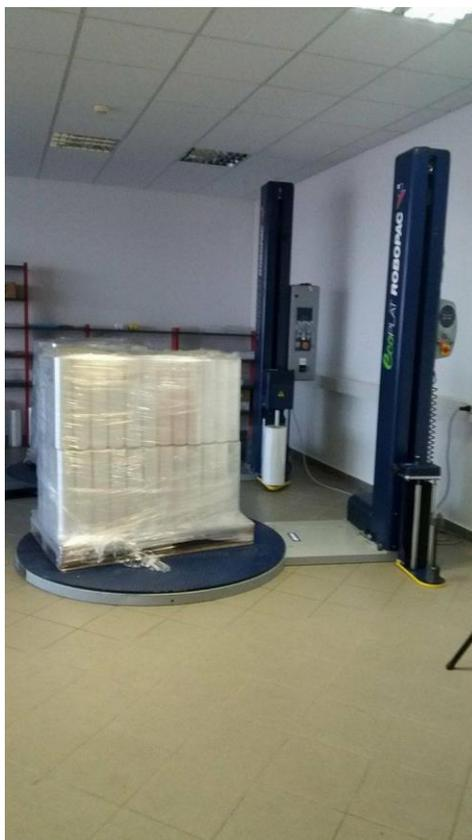
Slika 19. Stroj za ovijanje paleta – ECOPLAT
