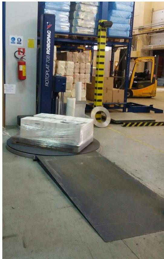
Slika 18. Stroj za ovijanje paleta – ROTOPLAT
