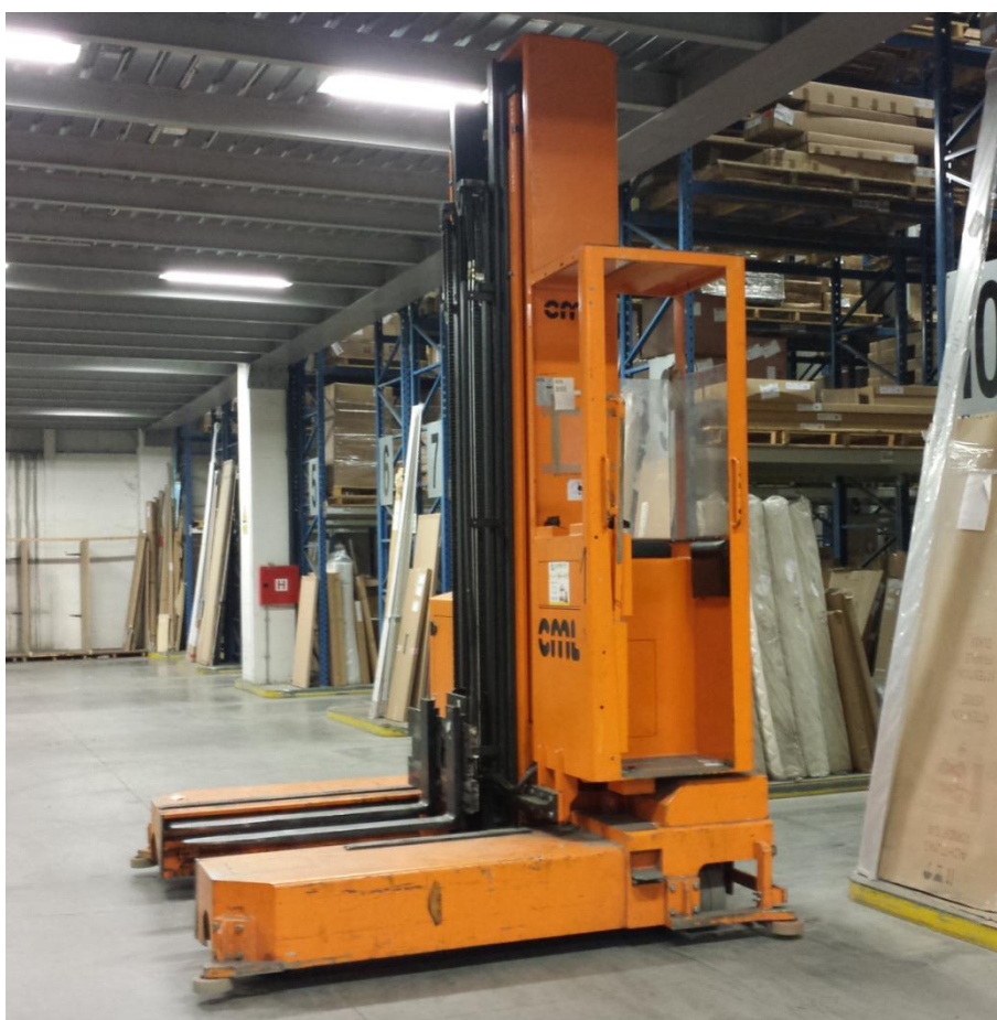
Slika 4.8 Električni bočni visokoregalni viličar
