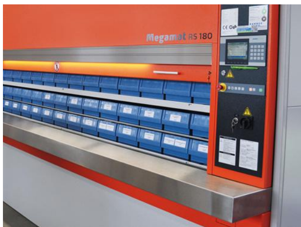
Slika 6.3. Prikaz vertikalnog karusela u tvrtki EKK Anlagentechnik [18]
