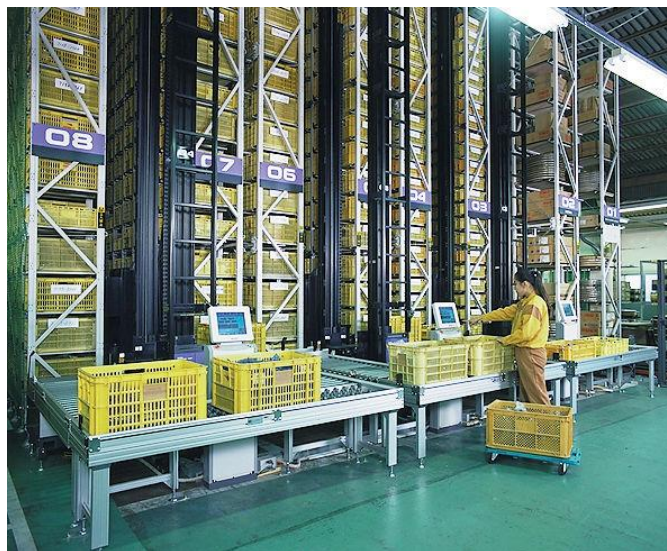
Slika 4.5. Prikaz mini i micro load AS/RS [24]
