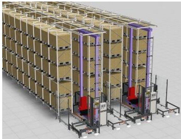
Slika 3.4. Automatizirano visoko regalno skladište ( Unit-Load AS/RS) [31]
