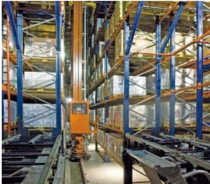
Slika 3.6. Automatizirano skladište za komisioniranje ( Person-on-bord AS/RS) [32]
