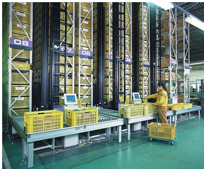
Slika 4.5. Prikaz mini i micro load AS/RS [24]
