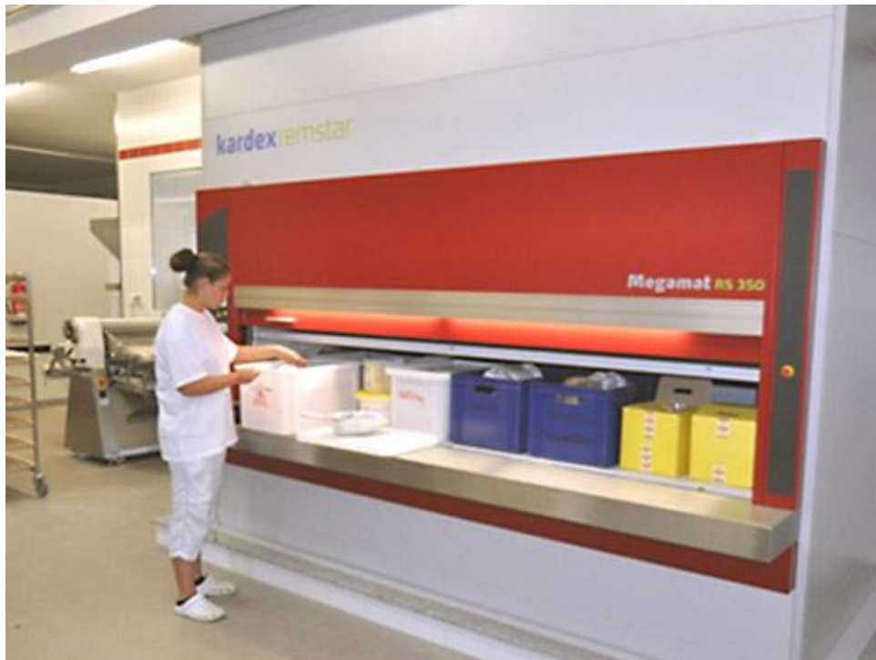
Slika 6.5. Vertikalni karusel u Miller Backerei [19]
