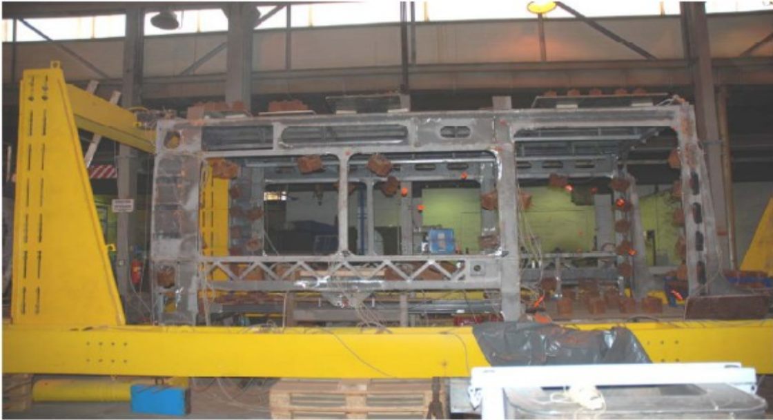
Slika 4.8: Ispitivanje sanduka u nadležnosti TŽV "Gredelj"
