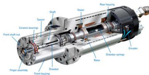
Slika 3.3 Motorvreteno [8]
