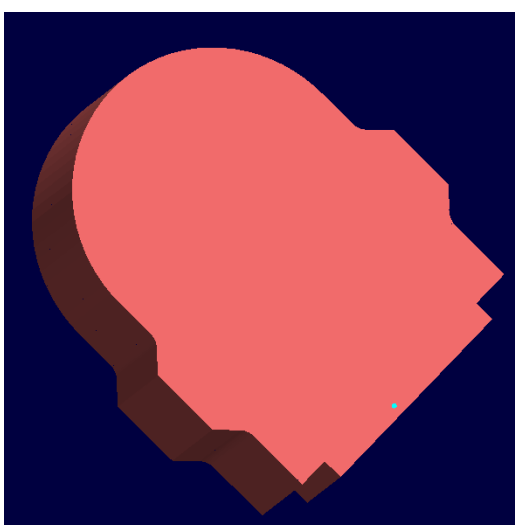
Slika 5.8 Sirovac nakon konturnog glodanja
