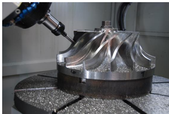
Slika 2.7 Izrada turbine na petoosnoj glodalici
