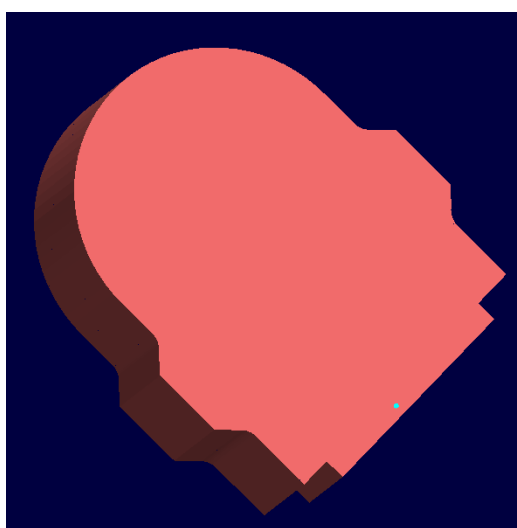
Slika 5.8 Sirovac nakon konturnog glodanja
