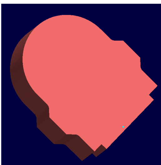
Slika 5.8 Sirovac nakon konturnog glodanja
