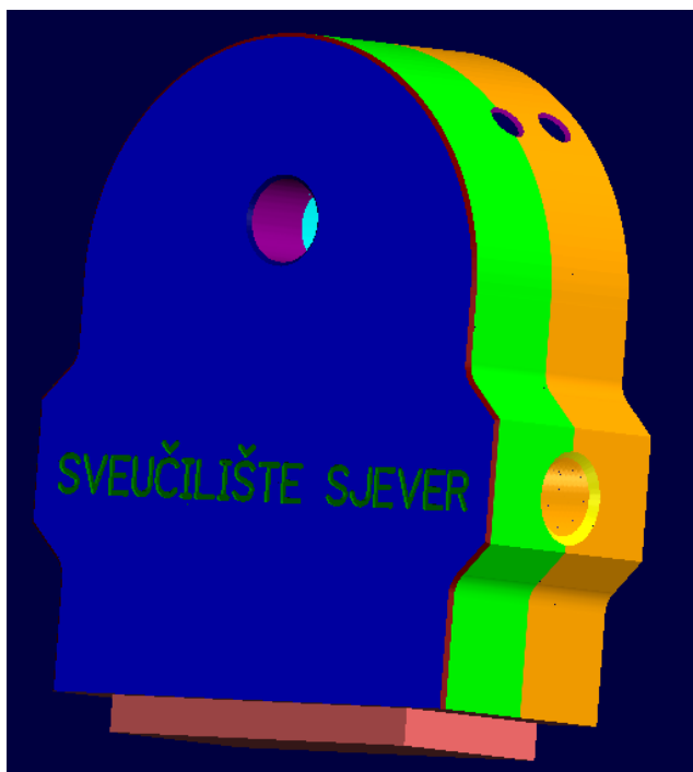
Slika 5.15 Obađena stezna naprava
