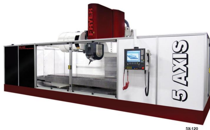
Slika 2.5 Fryer petoosna glodalica [9]
