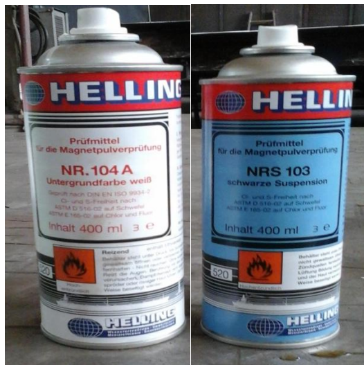
Slika 4.1.3 Temeljna bijela boja (lijevo) i suspenzija crnih magnetskih čestica (desno)
