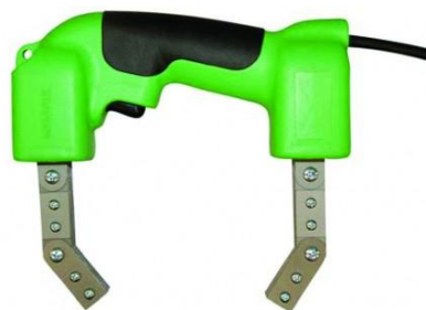
Slika 3.3.3 Elektromagnet za kontrolu magnetnim česticama [2]
