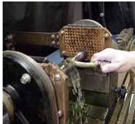
*Slika 3.3.7 Ispitivanje magnetskim glavama (direktna magnetizacija) [2]*
