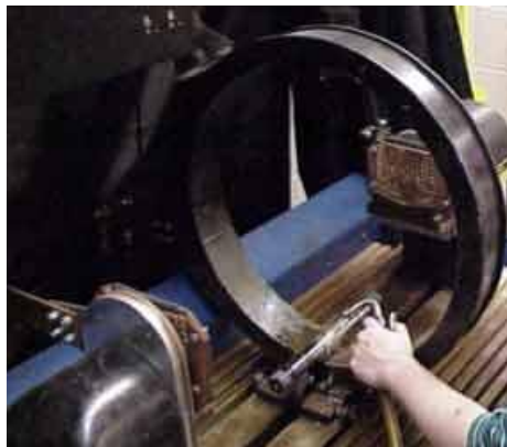
Slika 3.3.8 Ispitivanje zavojnicom (indirektna magnetizacija) [2]
