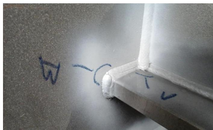
*Slika 4.2.3 Navar (desno - oznaka V) zbog premalog unosa topline i neobrađeni završetak zavara (lijevo – oznaka B)*
