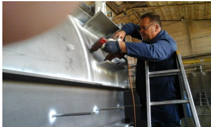
Slika 4.1.6 Nanošenje suspenzije i kontrola zavara
