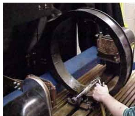
*Slika 3.3.8 Ispitivanje zavojnicom (indirektna magnetizacija) [2]*
