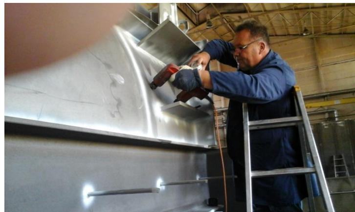
*Slika 4.1.6 Nanošenje suspenzije i kontrola zavara*
