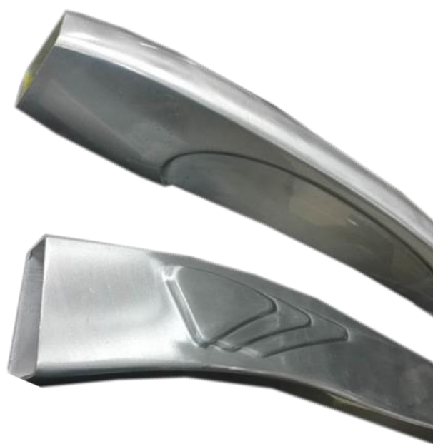
Slika 3.7 Prikaz oblikovanih aluminijskih cijevi [9]
