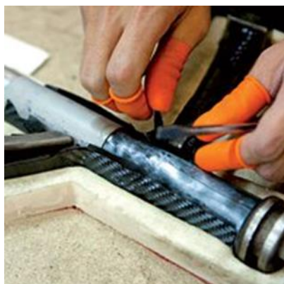
Slika 3.14 Ulaganje slojeva u kalup [11]
