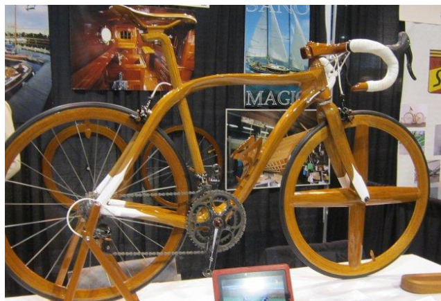
Slika 3.17 Okvir bicikla izrađen od drva [22]
