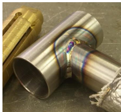
Slika 3.4 Spoj cijevi MIG zavarivanjem [6]
