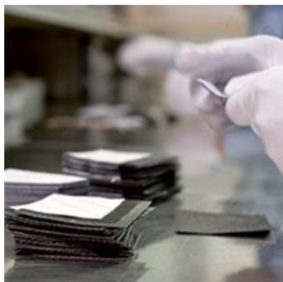
Slika 3.13 Priprema slojeva karbona [11]
