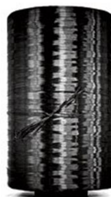
Slika 3.9 Sirovina za proizvodnju karbonskog pletiva [11]
