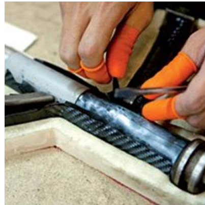
Slika 3.14 Ulaganje slojeva u kalup [11]
