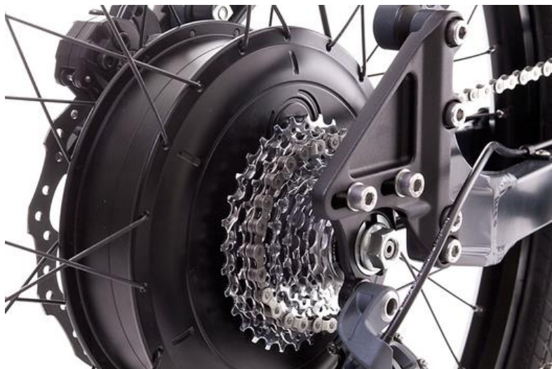
Slika 2.9 Prikaz direktnog hub motora [3]
