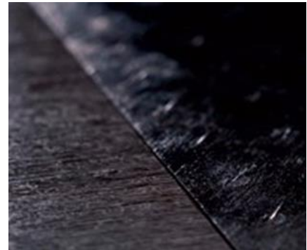
Slika 3.10 Uniform sloj karbona [11]
