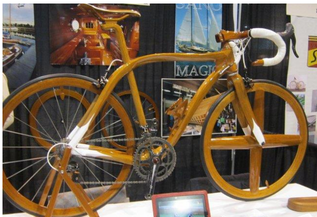
Slika 3.17 Okvir bicikla izrađen od drva [22]
