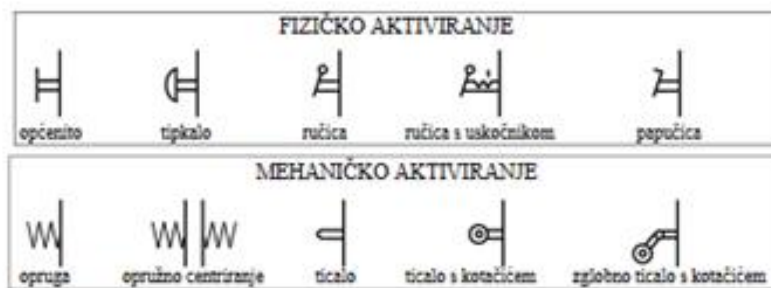
Slika 5.10 Fizički i mehanički način aktiviranja razvodnika [21]
