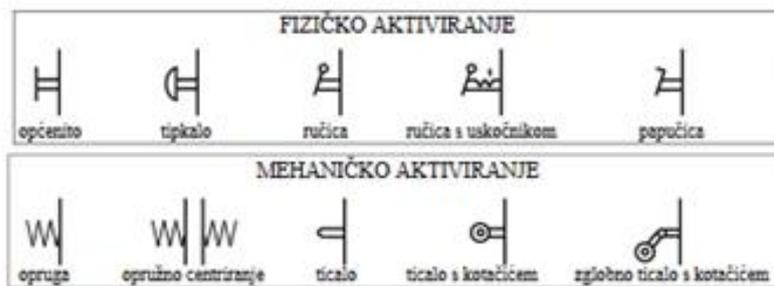
Slika 5.10 Fizički i mehanički način aktiviranja razvodnika [21]
