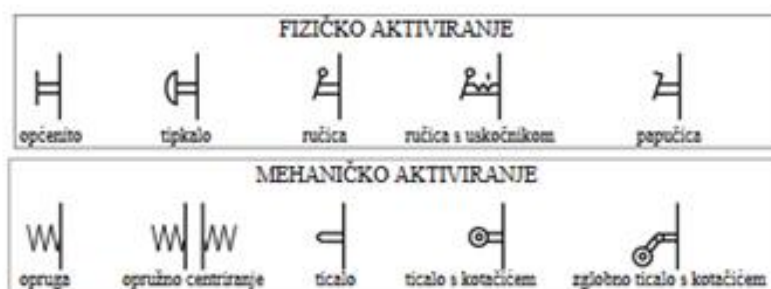
Slika 5.10 Fizički i mehanički način aktiviranja razvodnika [21]
