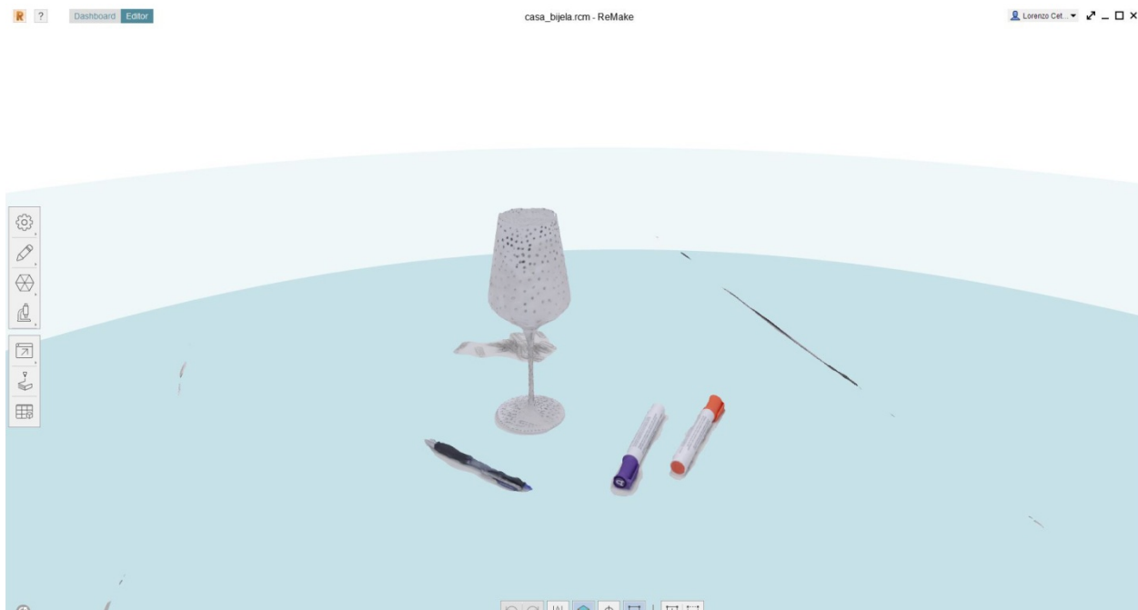
Slika 7.59 Test4 dodatak – Rezultat fotogrametrije – generirani 3D model 1
