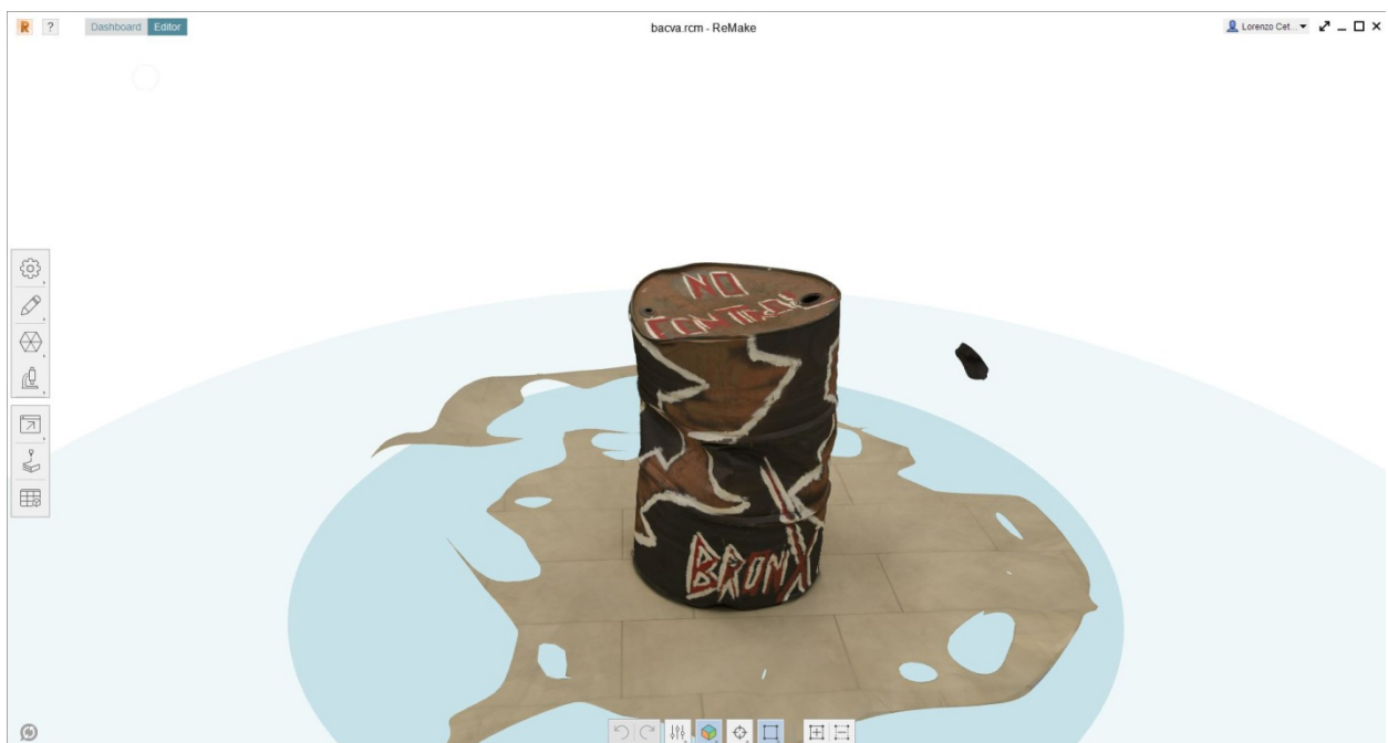
Slika 7.11 Test1 – Rezultat fotogrametrije – generirani 3D model 1
