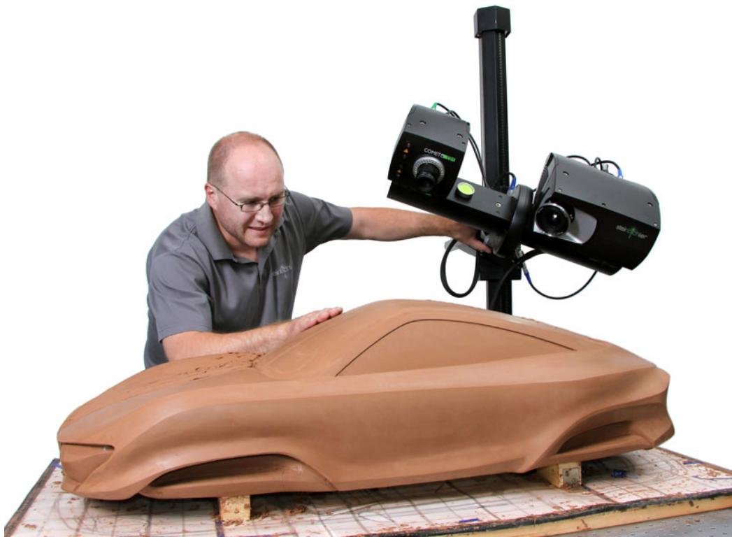
Slika 5.3 3D skeniranje strukturiranim svjetlom [35]
