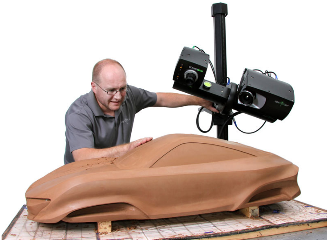
Slika 5.3 3D skeniranje strukturiranim svjetlom [35]
