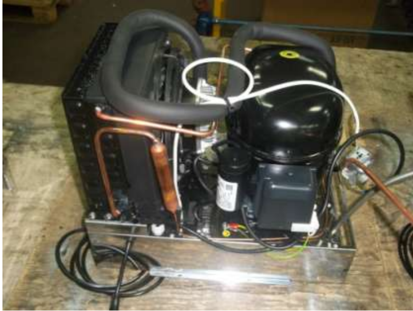
Slika 2.1.2.2.1. Izgled kondenzacijskog agregata
