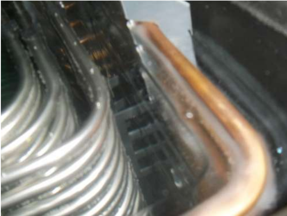
Slika 3.6.3. Stvaranje leda prilikom mokrog ispitivanja
